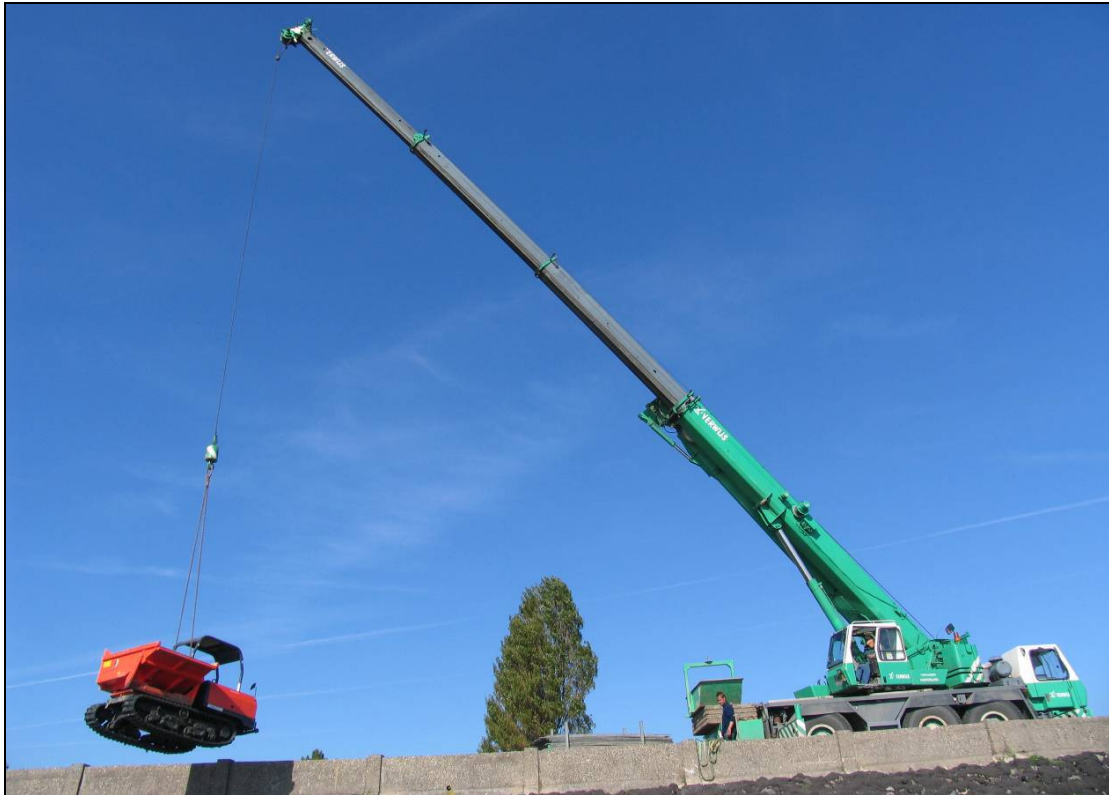
Foto 1. Uitschuifbare kraan zet de rupsdumper over de dijk en op de slikken.
