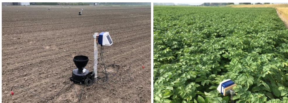
Figuur 9. Regenmeter en bodemvochtsensoren verbonden aan een telemetrische datalogger geïnstalleerd na het zaaien van uien in 2020 (links). Rechts dezelfde opstelling maar bij volle loofbedekking door het aardappelgewas op 17 juli 2019.
