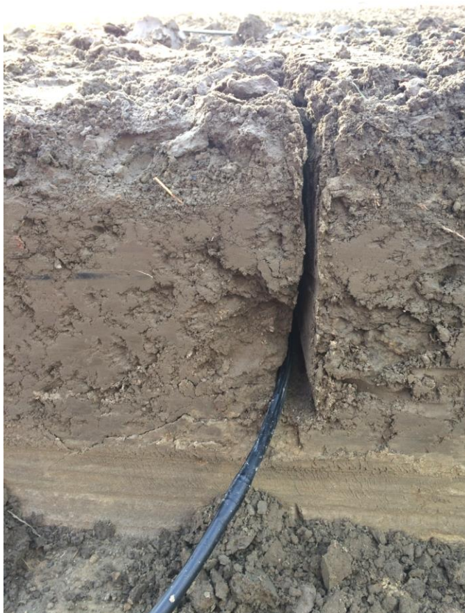
Figuur 7. Bodemopbouw in het druppelproefvak met een 40 cm dikke deklaag van zeer lichte zavel op kleiarm zand. De diepdruppelsslagen werden aangelegd in de lichte zavel enkele centimeters boven de zandlaag.
