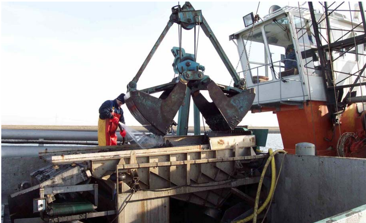
Figuur 22: Oesters worden vanuit de knijperbak op de schudzeef gestort (foto: J. Wijsman)
