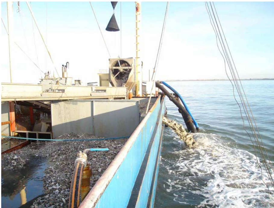
Figuur 37: Omgebouwde kokkelvisser aan het vissen op oesterschelpen met behulp van een zuigkor op de stortlocatie Middelplaat, januari 2007 (foto: J. Wijsman)
