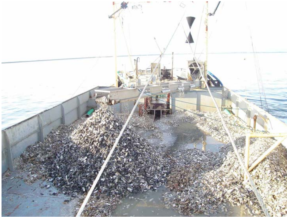
Figuur 38: Opgeviste schelpresten worden gespoeld en in het ruim gestort (foto: J. Wijsman)
