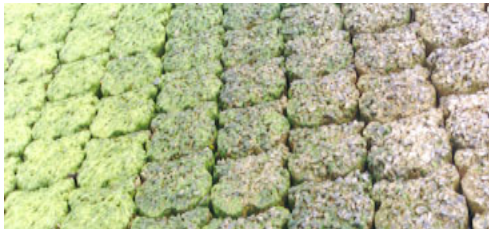
Figuur 34; Betonzuilen, in dit geval Haringman Hydroblocks met ecotoplaag van uitgewassen lavasteen Betonzuilen met ecotop zijn ontworpen om de ecologie ten goede te komen, een ruw oppervlak zorgt voor een betere aanhechting van organismen.
