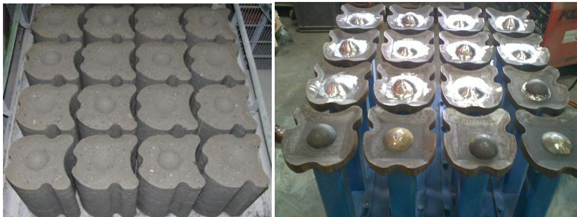
Figuur 12; Betonzuilen met kuil-ecotop en stempel
