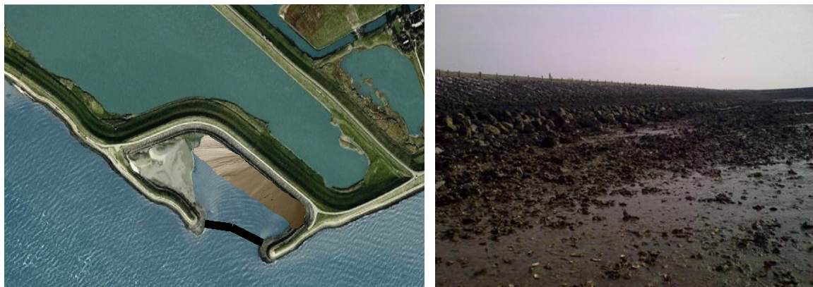
Figuur 6: Drempel en suppletie van zandige klei bij strekdammen voor Flaauwersinlaag en foto van locatie voor zandige klei lichaam.
