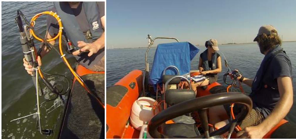
Figuur 2.2 Links: De camera, verlichting en zuurstofmeter. Rechts: opstelling met beeldscherm en videosysteem op de RIB.
