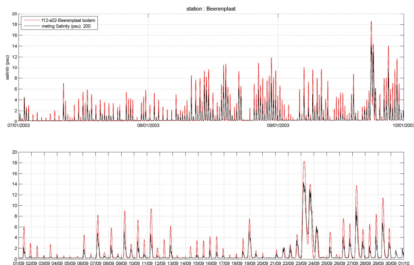
Figuur 2.3 Berekende (in zwart) en gemeten (in rood) saliniteit ter plaatse van de Beerenplaat (noodinlaat Evides)
