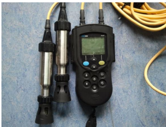
Fig. 11: Hach HQ Field case, pH en zuurstof, temp.
