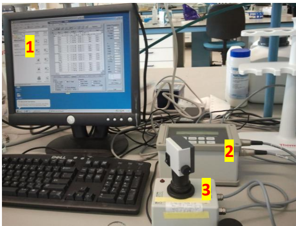
Fig 13: weergave van PAM (pulse amplitude modulation) 1: monitor waar de gegevens worden afgelezen 2: Besturingssysteem PAM 3: licht sensor en detectie
