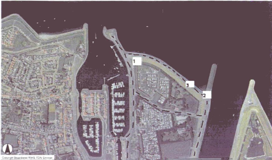
Figuur 8. Locaties die mogelijk gebruikt gaan worden voor tijdelijke opslag van kleine hoeveelheden materiaal (1,2,3) en transportroutes (stippellijn) bij de dijkverbetering
