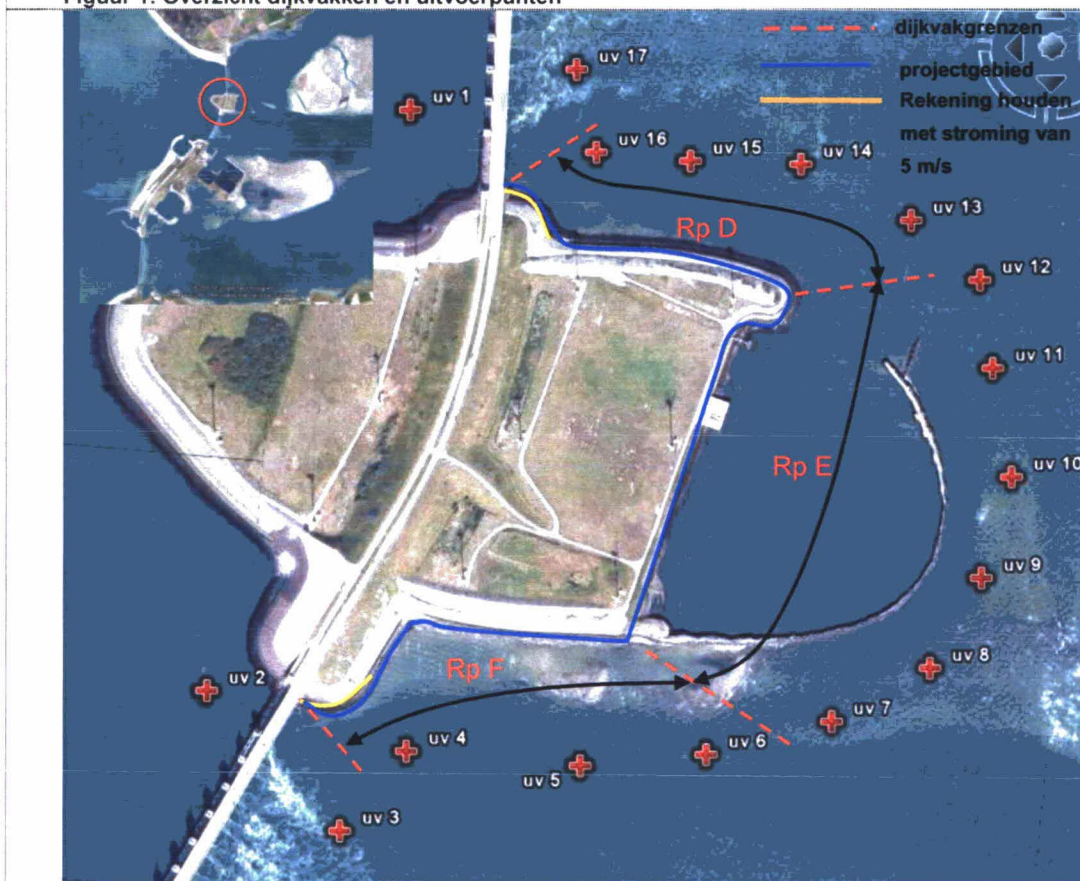
Figuur 1: Overzicht dijkvakken en uitvoerpunten
