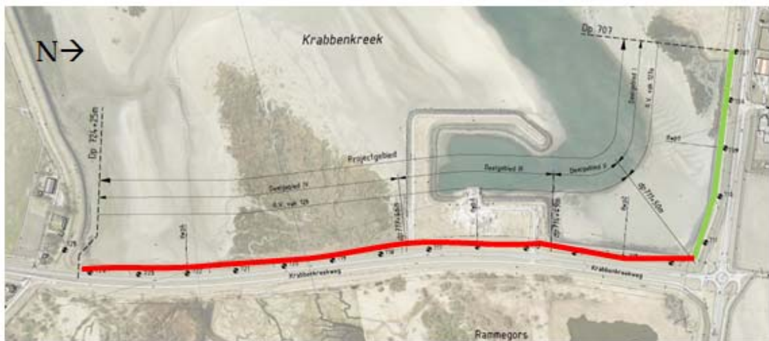
Afbeelding 4: Afwerking van de delen van het onderhoudspad. Groen wordt afgewerkt met dicht asfaltbeton. Rood wordt afgewerkt met niet-befietsbaar open steenasfalt.
