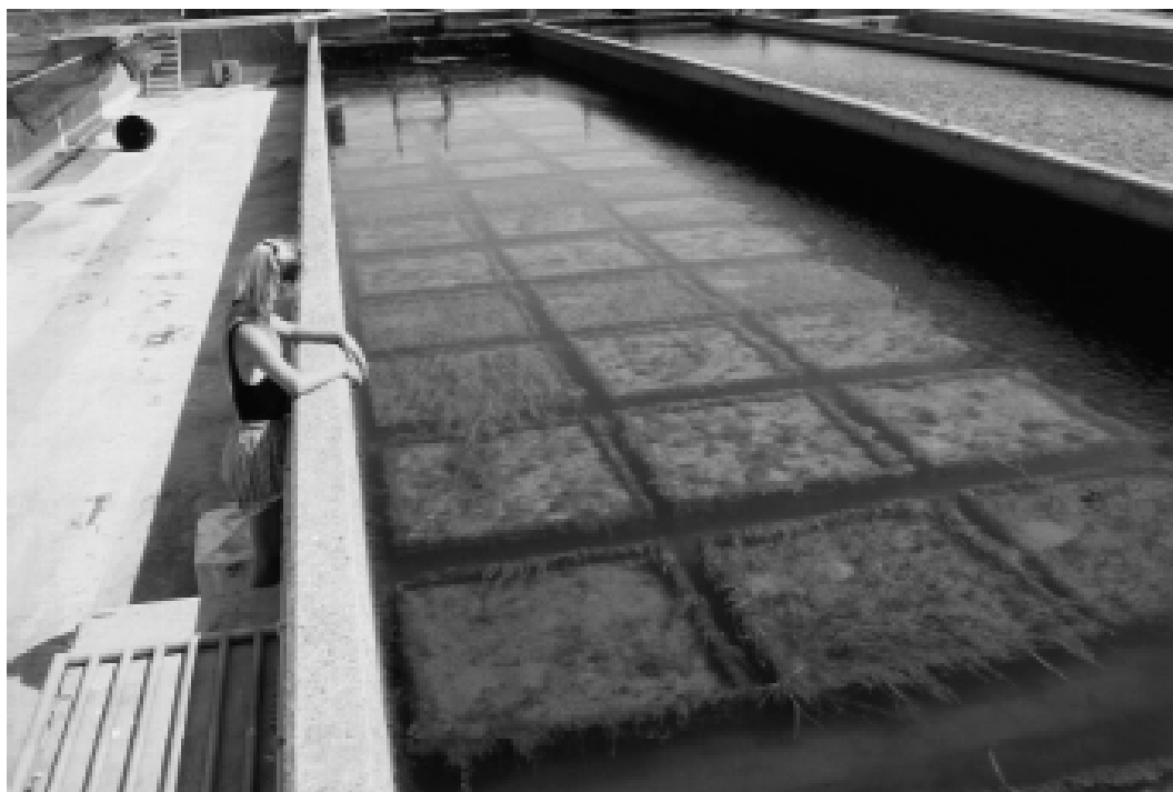
Figuur 9 Een mesocosm-bassin van 5x50 m met daarin bakken met groot zeegras. Voor de foto zijn de beschaduwende netten weggehaald en is het waterpeil verlaagd (uit: van Katwijk et al. 1998).
