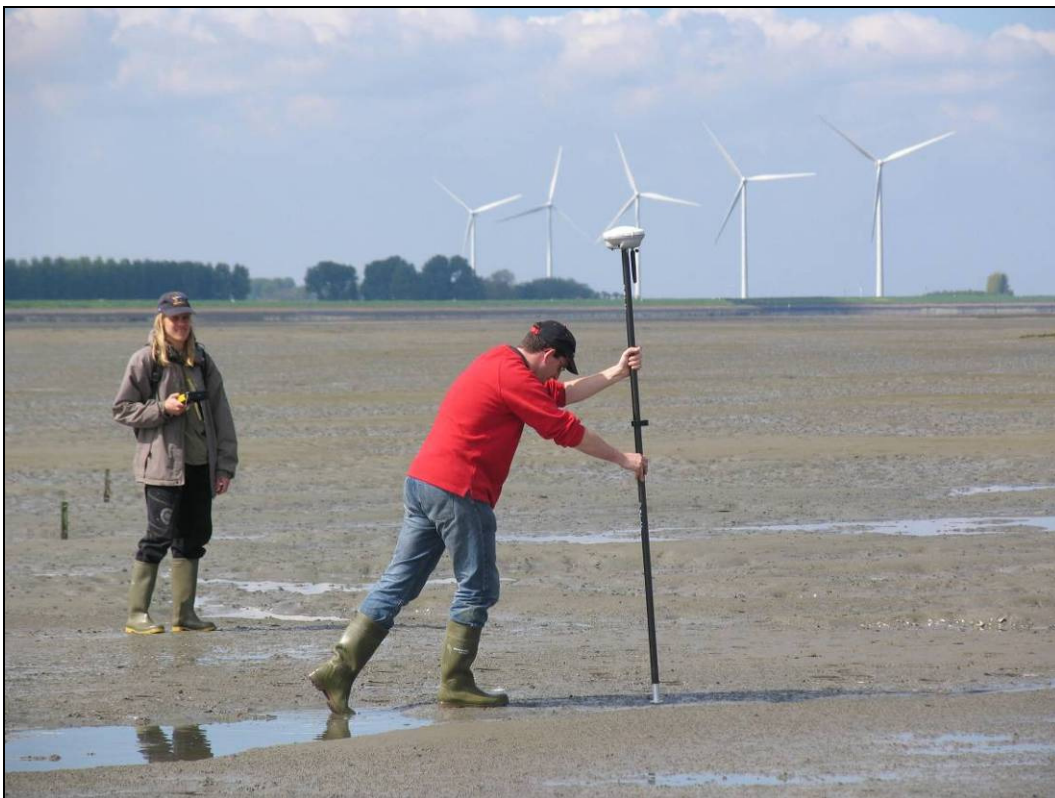
Foto 8: Meten van hoogtes m.b.v. een RTK-DGPS in de kansrijke plots (hier op KN08)
