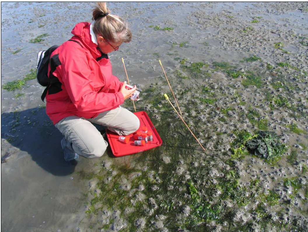
Foto 10: Nemen van sedimentmonsters op verschillende dieptes in het zeegras van RH08, 2 sept. 2009
