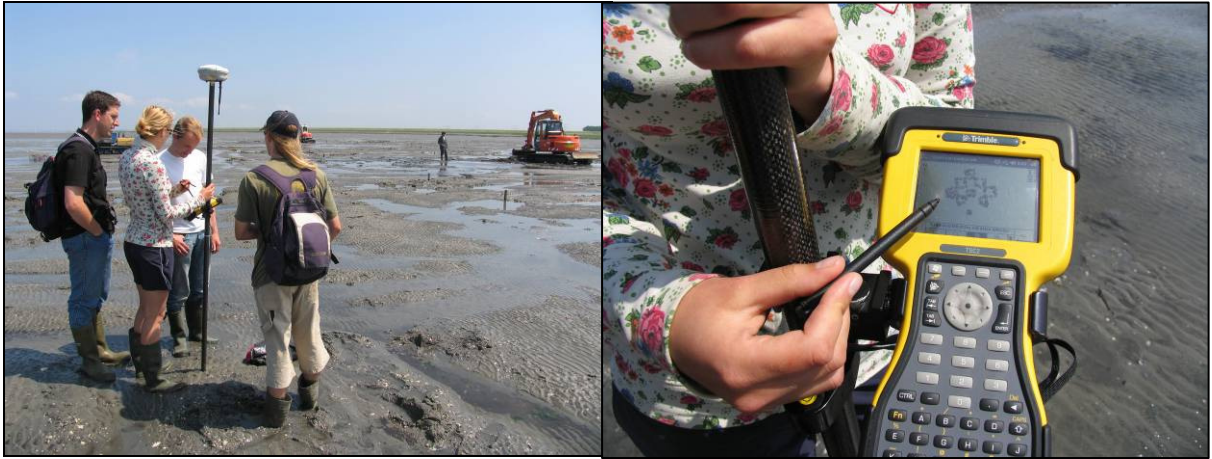
Foto 6: Opnames met RTK-DGPS op Roelshoek – 6a (links) de opstelling met antenne, 6b (rechts) de meter
