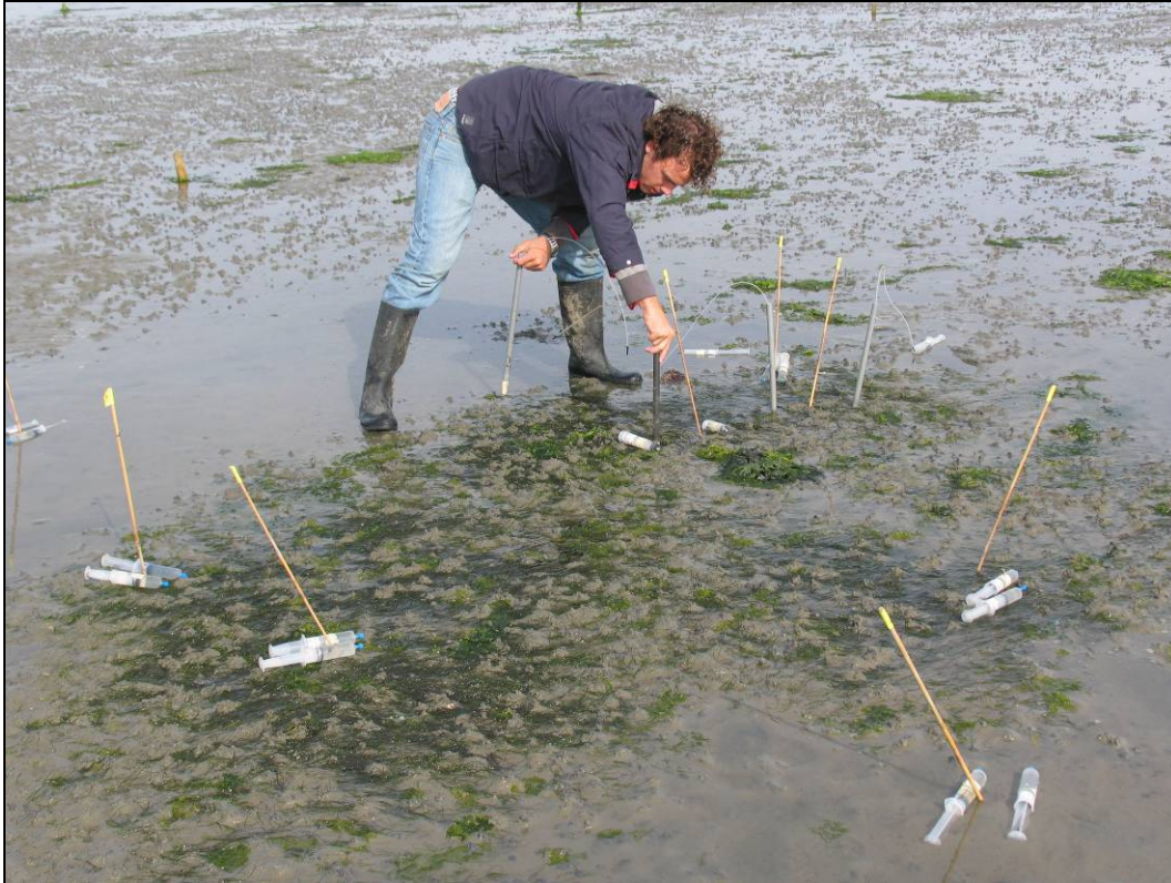
Foto 9: Nemen van porievochtmonsters met behulp van spuitten waaraan 'sippers' zijn bevestigd, hier in het zeegras van RH08, 2 sept. 2009
