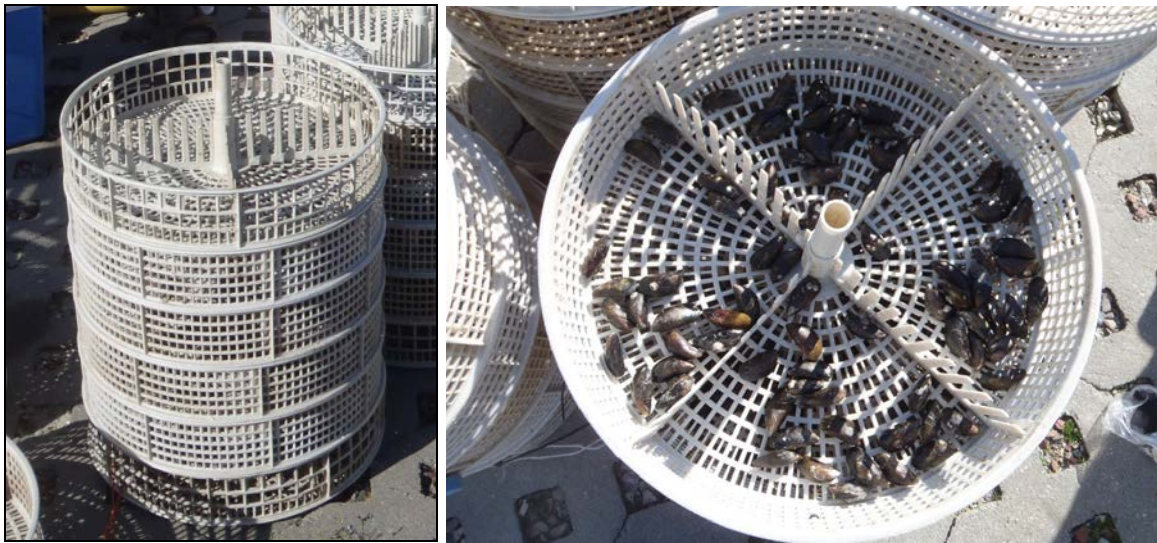
Figuur 4: In 2011 bestond een toren uit 6 ringen (links). De onderste en bovenste ring zijn leeggelaten. Iedere ring is onderverdeeld in 4 compartimenten (rechts) waar 20 mosselen in zijn gebracht.
