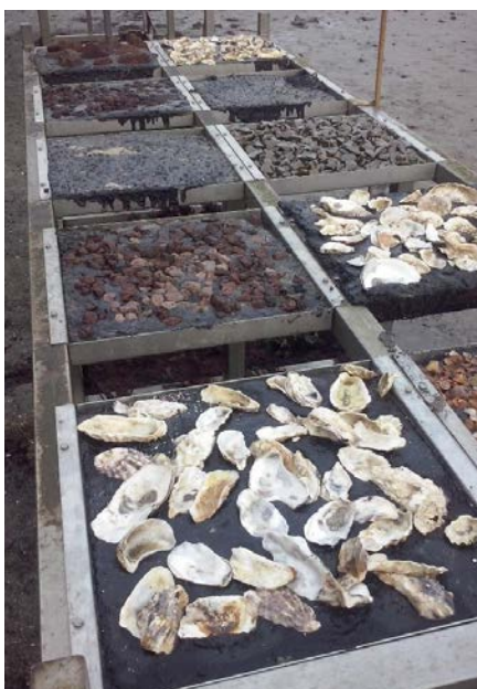
Testopstelling naar gebruik van eco-toppings op gietasfalt.
