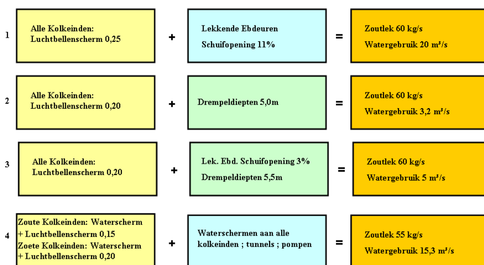
Figuur 6.1 Overzicht van de belangrijkste varianten voor het beperken van de zoutlek door de Volkeraksluizen tot maximaal 60kg/s met hooguit 25 m 3 /s watergebruik.
