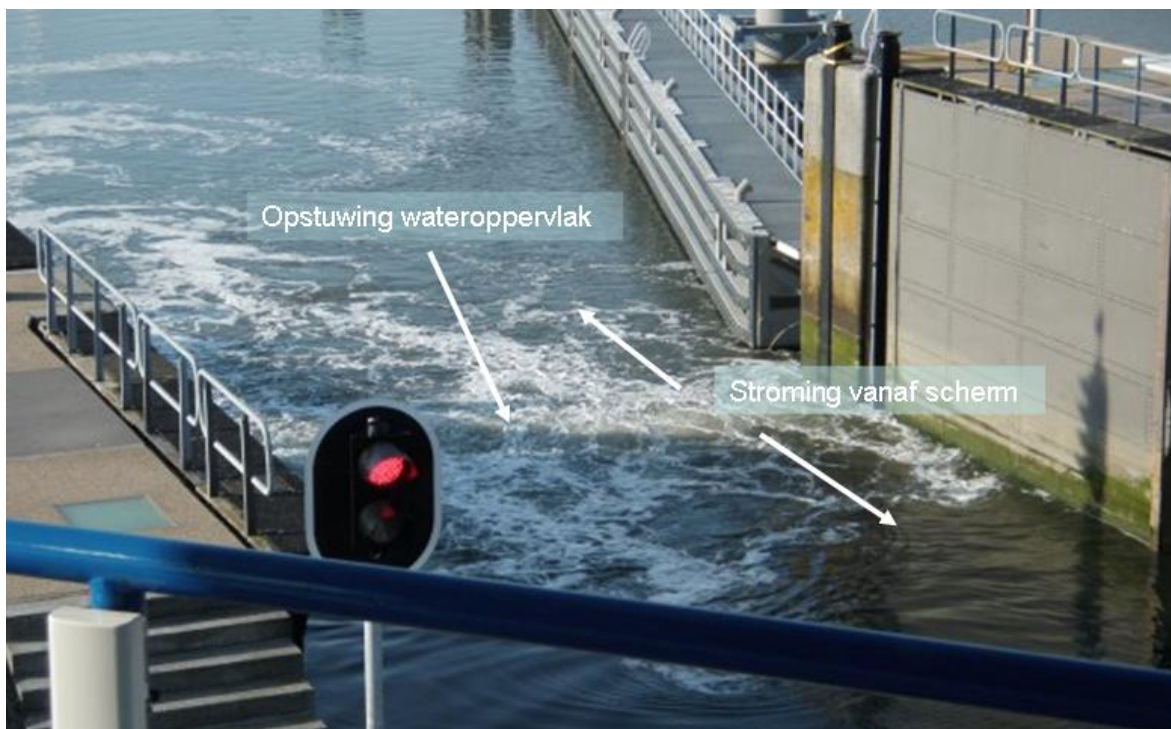
Figuur 3.9 \Delta -luchtbellenscherm (Figuur 3.8) met 400 Nl/s luchtdebiet aan de zeezijde van de Stevinsluis.
