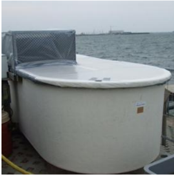
Fig. 7 Een raceway afgedekt met plastic folie ter voorkoming van contaminatie
