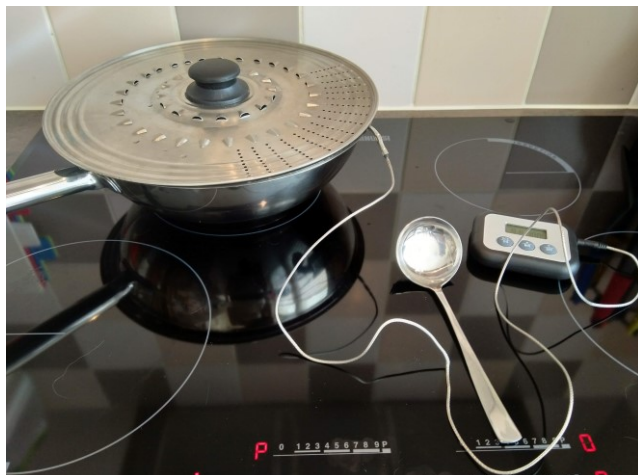
Figuur 1. Standaaropstelling van de extractie van anti-aanbakpannen met kokend water.
