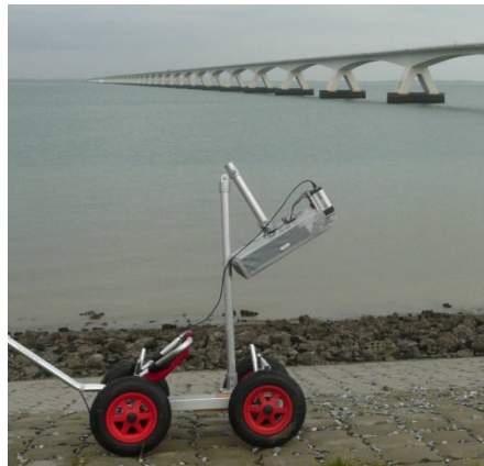
Figuur 2 – L-band en thermische infrarood metingen op de dijk
