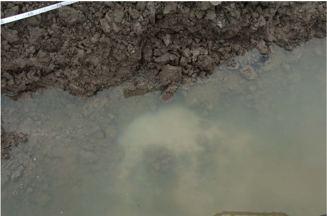
2.9: Zandspoor en vertroebeling water bij IJdkijkproef. [Deltares DSC9981]
