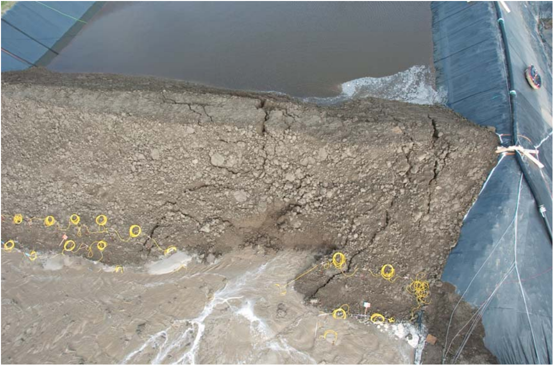
2.17a: Bezwijken door inzakken dijk bij IJkdijkproef [Deltares DSC0476]
