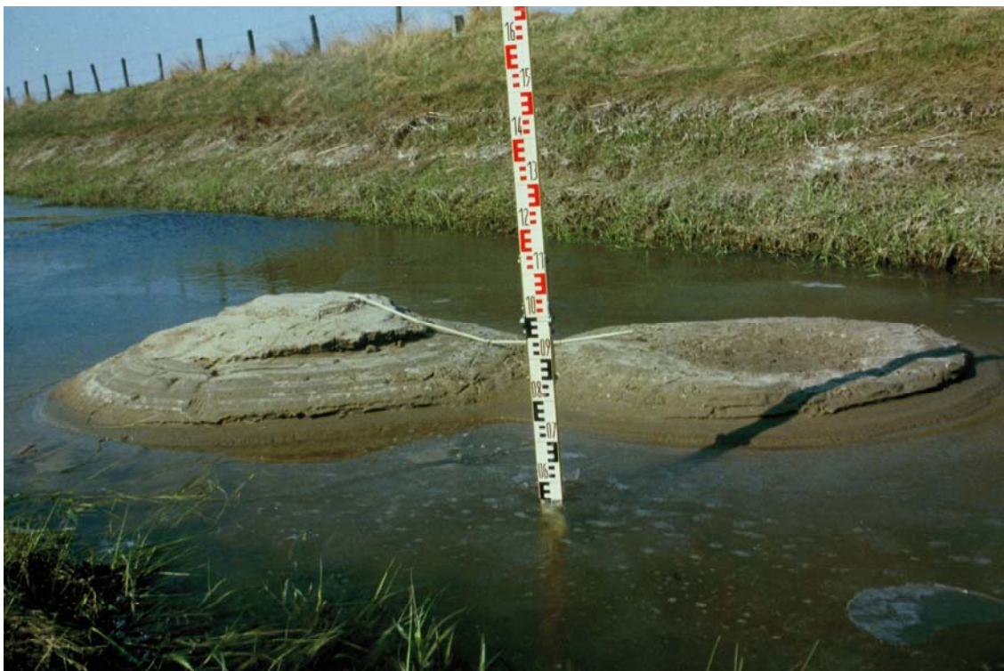
2.14d: Zandmeevoerende wellen in teensloot bij Pannerdens kanaal. [RWS-DWW 134_24] [ www.BeeldbankVenW.nl , Rijkswaterstaat: RWS-DWW_31000]
