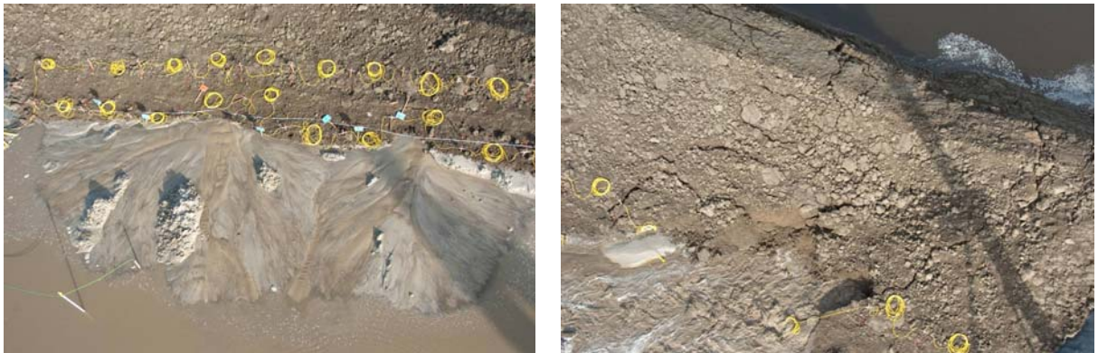
Figuur 4.13 Doorbraak (toename zandtransport links en dijkdoorbraak rechts)
