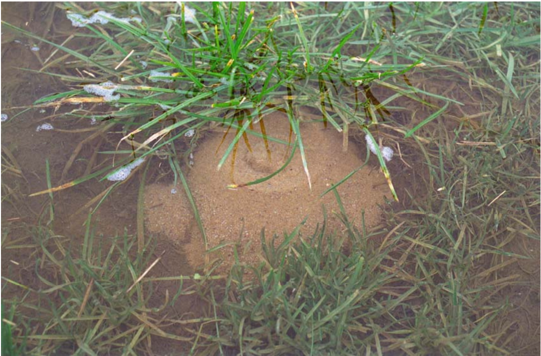
2.13c: Kleine zandmeevoerende wel op maaiveld achter de dijk. [RWS-DWW 905_05]
