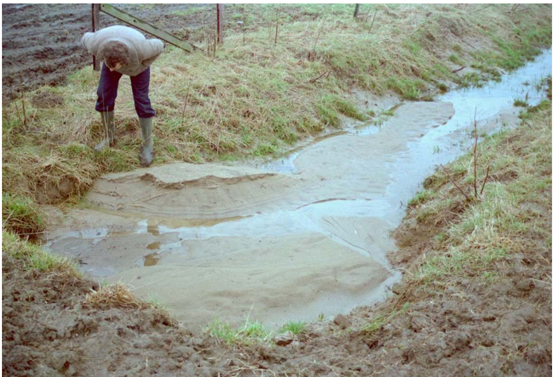
2.14e: Zandmeevoerende wellen in teensloot bij Pannerdens Waard. [RWS-DWW 218_1]
