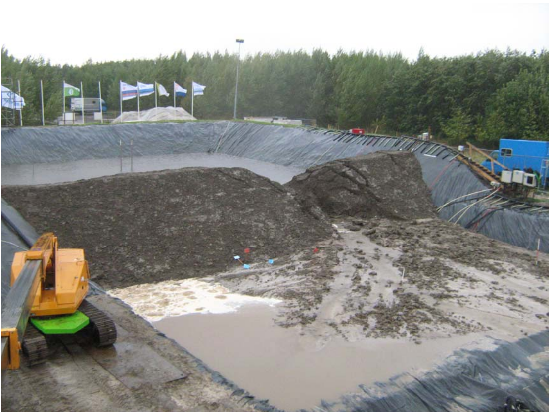
2.17b: Dijkdoorbraak naar inzakken en overstromen bij IJkdijkproef [Deltares IMG_0774]
