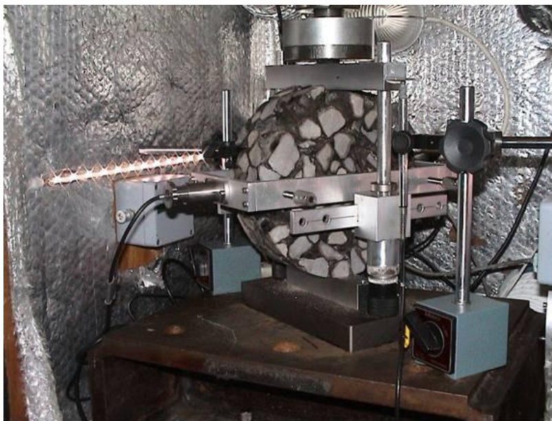
Figuur 6-2: Schijf van open steenasfalt in de ITT-proefopstelling
