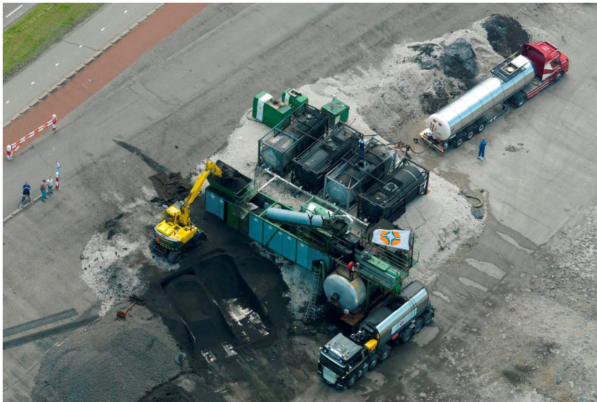
Figuur 8-6: Opmenginstallatie voor gietasfalt en asfaltmastiek (foto Hydraphalt)
