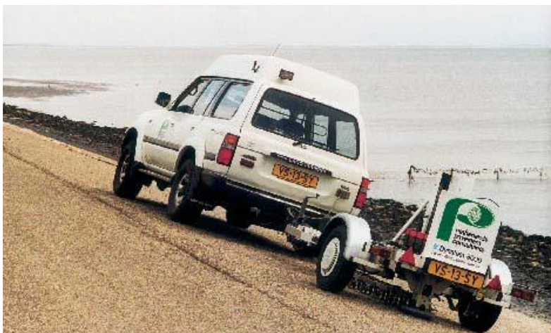
Figuur 10-6: Valgewicht-deflectiemeter op een dijktalud (foto NPC)
