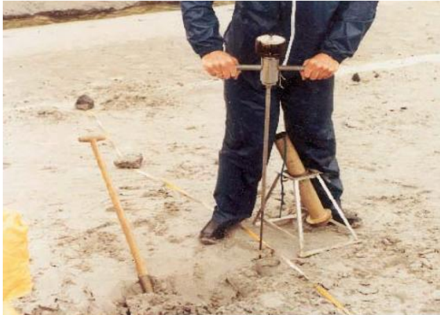
Figuur 8-3: Dichtheidscontrole van het zandbed met handsondeerapparaat en steekring – Sjoukeshoek, 1983
