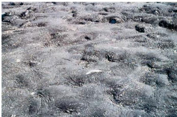
Figuur 8-20: Penetratie van gietasfalt - "volledige penetratie"
