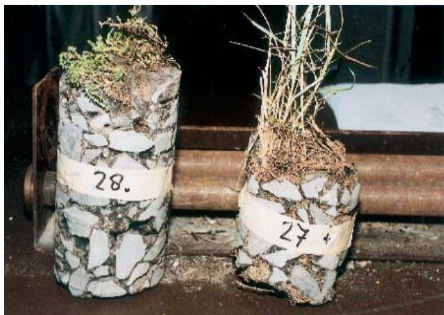
Figuur 11-16: Boorkernen uit een begroeide bekleding van open steenasfalt - Tholen – 1995 (foto Oranjewoud)
