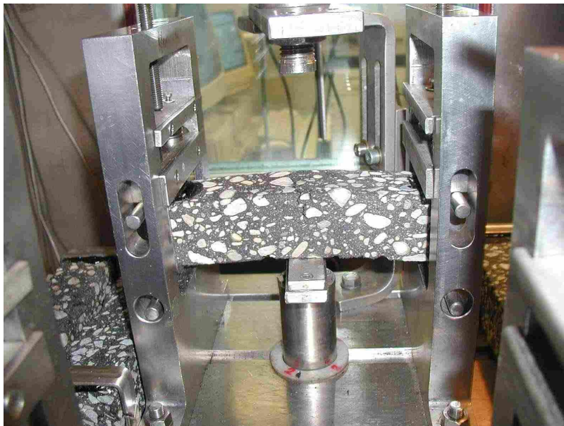
Figuur 6-1: Bezijken van een proefstuk in de driepunts-buigopstelling
