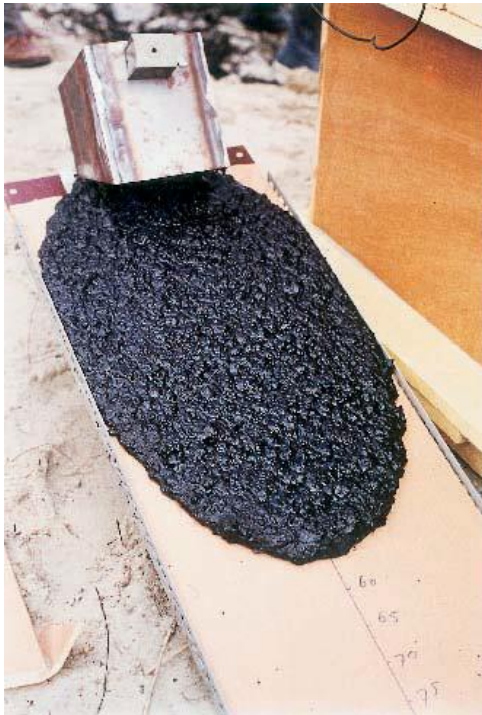
Figuur 11-10: Hellingproef voor het bepalen van de viscositeit
