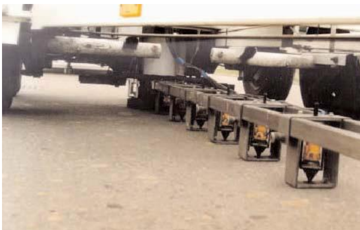
Figuur 10-7: Valgewicht-deflectiemeter: meetbalk met geofoons (foto NPC)
