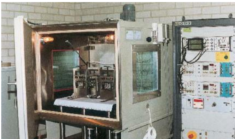
Figuur 11-8: Testbank met klimaatkast voor het uitvoeren van dynamische proeven (foto NPC)
