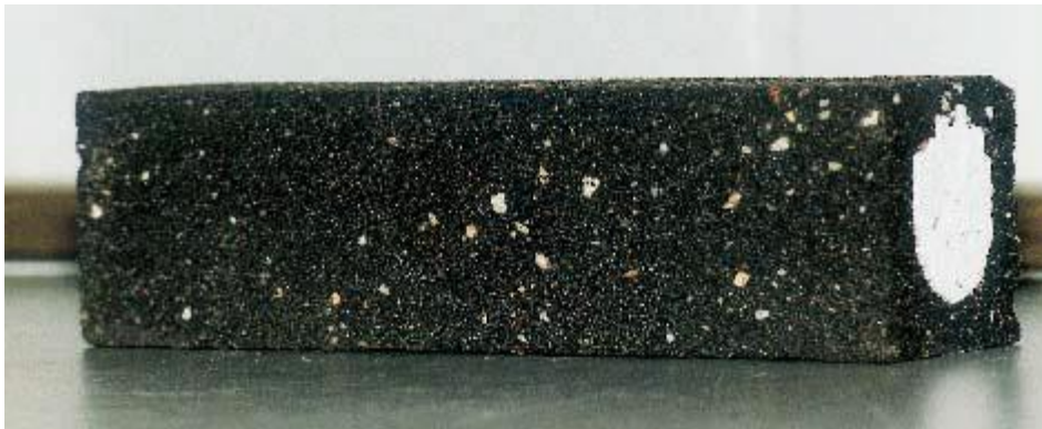
Figuur 11-17: Balkje uit een bekleding van zandasfalt - 1998 (foto NPC)
