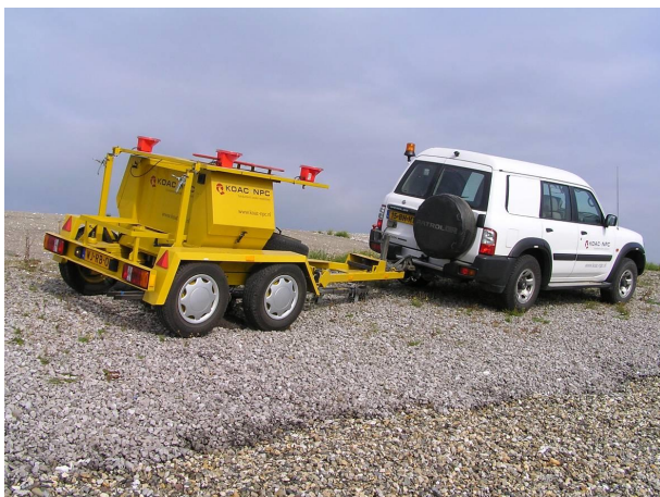
Figuur 10-8: Valgewicht-deflectiemeting op een talud op een bekleding van open steenasfalt
