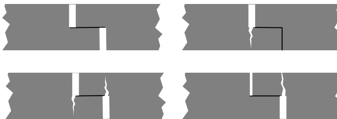
Figuur 9-3: Een aantal denkbare varianten van openstaande naden in geval van een liplas
