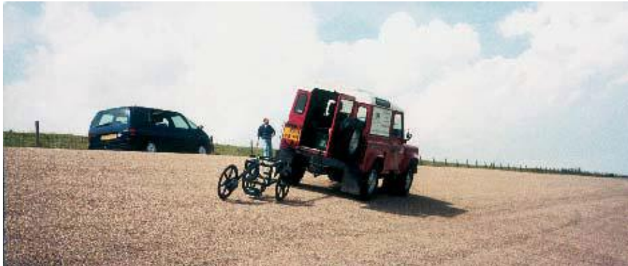
Figuur 10-3: Radarmetingen op de asfaltbetonbekleding van Texel - 1999 (foto NPC)
