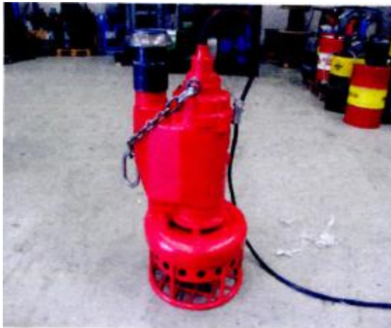
Figuur 2.5 Slibpomp geplaatst in vloeistofdichtebak
