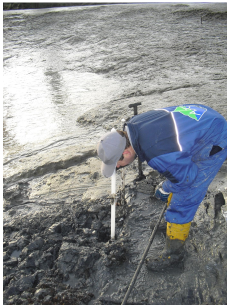
B: Het plaatsen van peilbuis P3.
