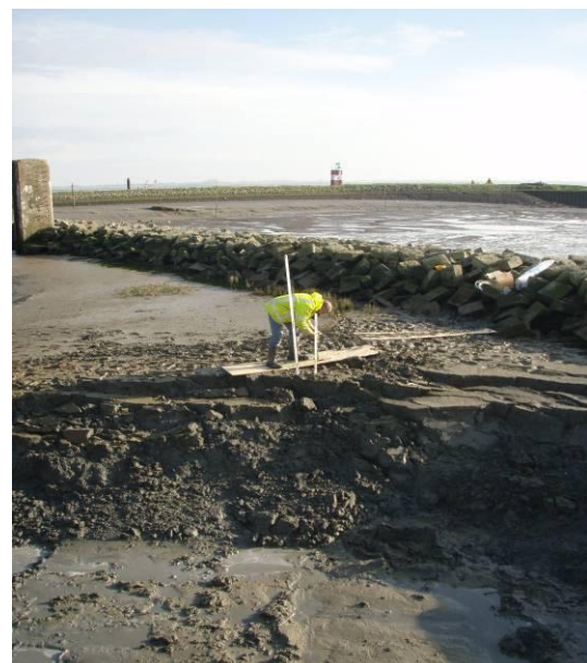
D: Bemonstering van peilbuis, onttrekken van grondwater.
