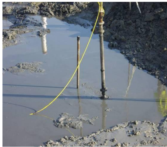
D: Uitstroom van versterkt sediment. Gele slang is toevoer van waterglas, in het stuk na de toevoer van waterglas bevindt zich de statische menger.
