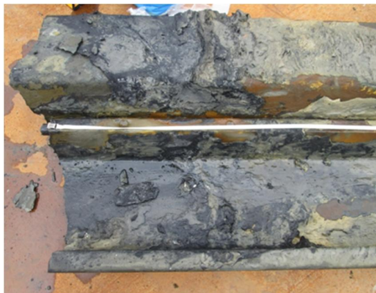
Afbeelding 1.4: plank Hollandsche IJsselkering: een dikke klonterige deklaag [RWS-GPO 2015a]
