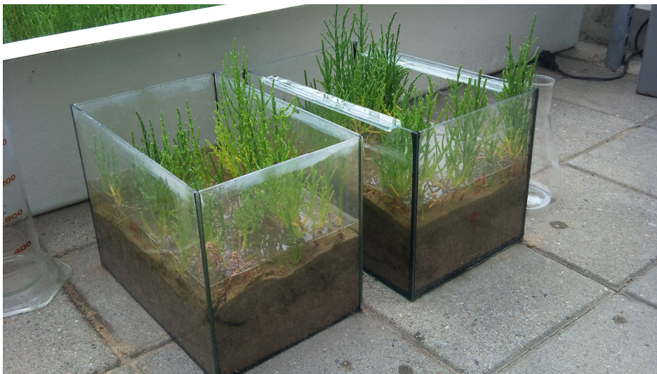
Figuur 28. Foto van de experimentopzet naar inundatie van zeekraal door een regenbui; twee aquaria met zeekraal na toevoeging van het equivalent van 30mm regen.
