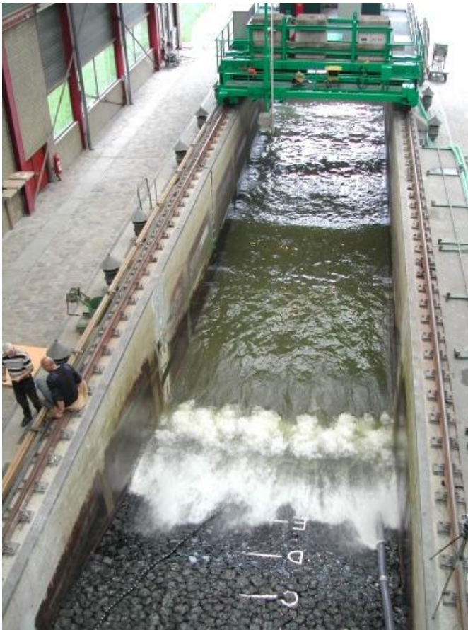
Figuur 1.1, golfbelasting op ingegoten basalt in Deltagoot
