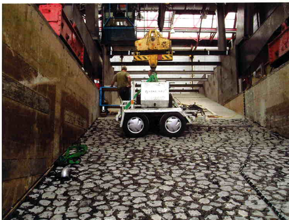
Figuur 3.1: meetopstelling van de VGD-metingen in de Deltagoot
