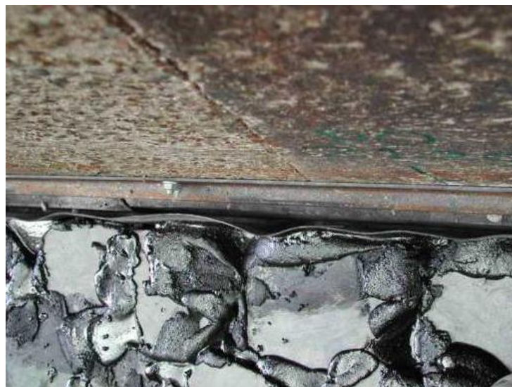
Figuur 2.7. Randafwerking van de toplaag bij proevenserie 1.
