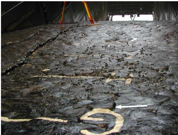
Figuur 2.17. Toplaag na proef P15: nog weinig schade te zien (behalve de bult).
