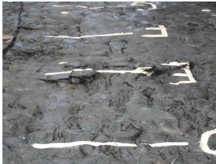
Figuur 2.20. Detail foto van talud na proef P17, ver boven SWL.
