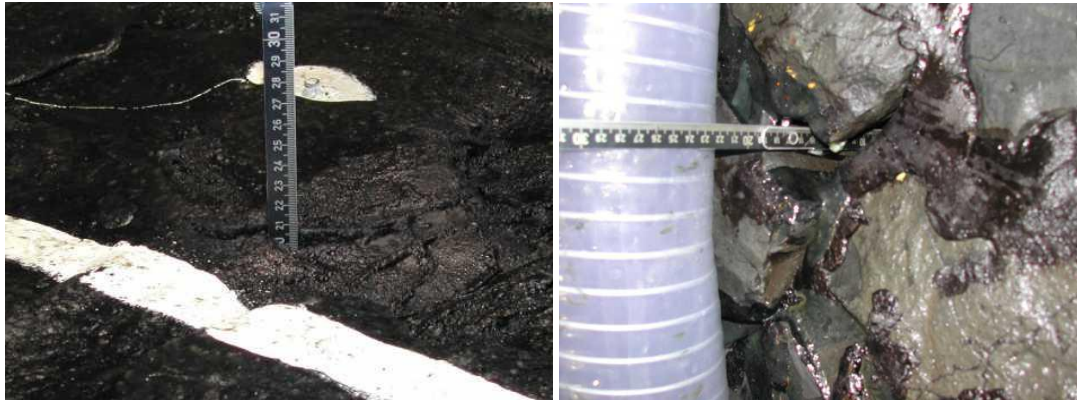
Figuur 2.19. Scheuren in toplaag na P16. Links: bij E. Rechts: bij C.
