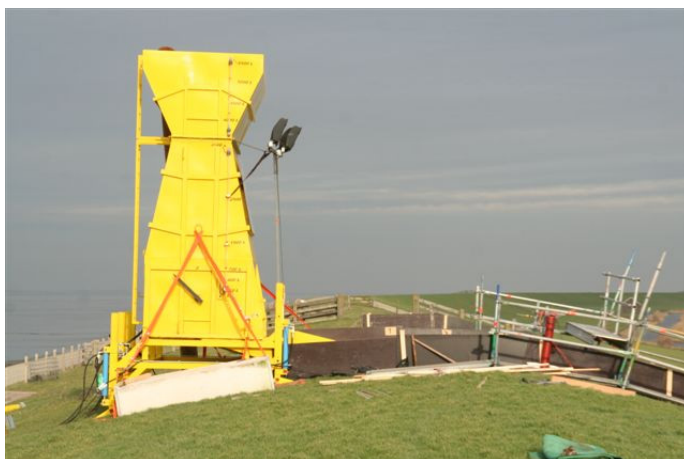
Figuur 3-9 Zijaanzicht van de vergrootte simulator in Friesland. De simulator staat op een apart onderstel wat met hydrauliek eenvoudig is te verstellen.
