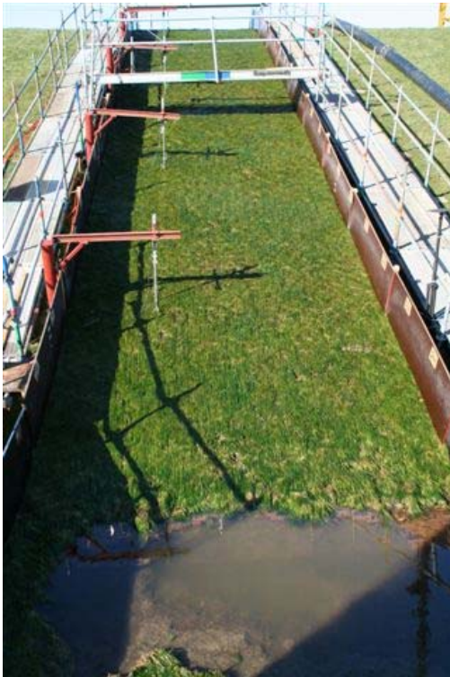
Figuur B3. Eindresultaat Boonweg, eerste sectie. Kleidek van 0,6 m op zandkern. Normaal beheer (hele zomerseizoen beweiden, bijmaaien en 70 kg/hectare stikstof). Geen schade aan talud na 75 l/s per m; Na 4 uur van 50 l/s per m beschadiging horizontale deel (teen), waar een oud klinkerpaadje aanwezig bleek. Deze schade zette zich door bij 75 l/s per m (foto rechts).
