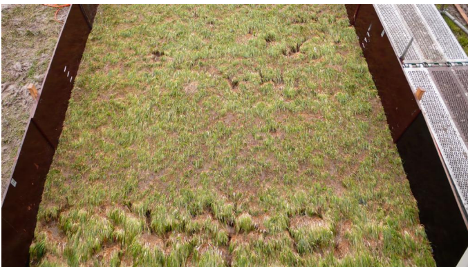
Figuur 8-2 De toestand van het talud na twee sessies 50 l/s per m
