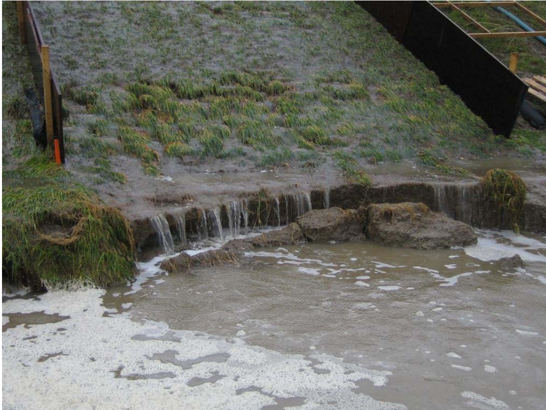
Foto F-12 Als gevolg van terugschrijdende erosie "kroop" het gat langzaam richting het talud (met kleidam en grindkoffer).
