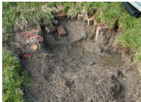
Figuur B4. Eindresultaat Boonweg; tweede sectie. Beheer: tweemaal beweiden, tweemaal hooien en geen stikstof gedurende 17 jaar. Geen schade talud na 75 l/s per m. In laatste uur van 75 l/s per m beschadiging aan de teen (klinkerpaadje, zie foto rechts).
