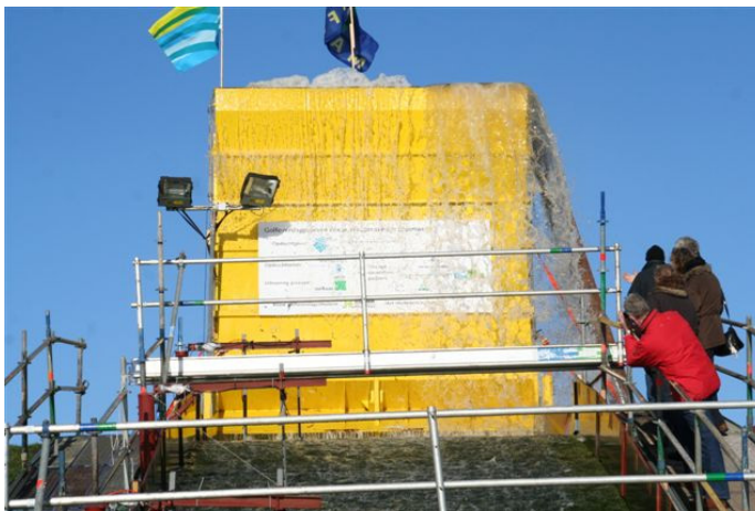
Figuur 3.11 De golfoverslagsimulator gevuld met meer dan 22 \text{ m}^3 water.
