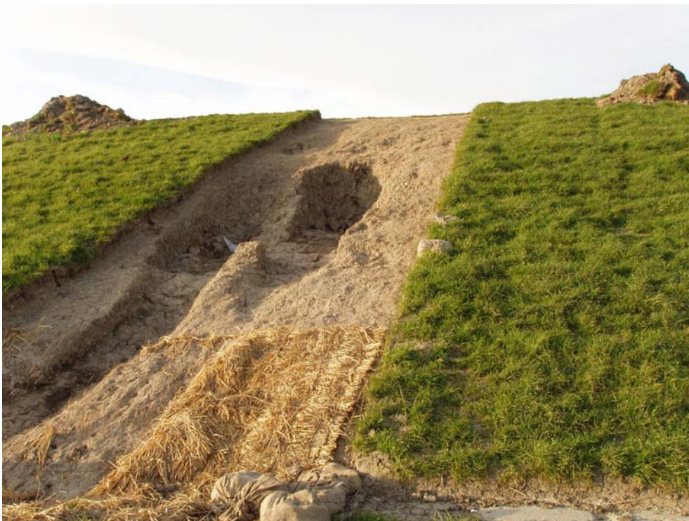
Figuur B2. Eindresultaat Delfzijl. Kale kleidijk (0,2 m grasbedekking weg gehaald). Debieten van 1; 5; en 10 l/s per m gedurende elk 6 uur. Erosie bij elke proef, bij het grootste gat uiteindelijk uitmondend in head cut erosie (horizontaal deel met verticaal talud; verticaal talud brokkelt af en het gat vergroot zich naar boven).
