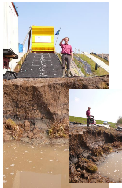
Figuur 10-3 Beschadiging onderhoudsweg (links) en gat achter onderhoudsweg (rechts) na uitvoering proeven op open steenasfalt
