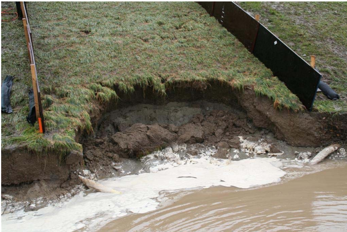
Foto F-13 Zodra de zandkern bloot kwam te liggen ontstond door het uitspoelen van het zand snelle doorgaande erosie het talud op. Het talud brokkelde daarna snel af, waardoor het ontstane gat naar boven toe snel groter kon worden. Om verdere schade te voorkomen is de proef gestopt.
