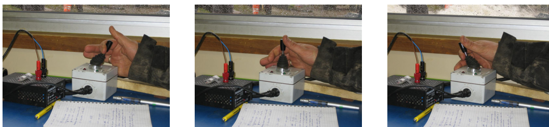
Figuur 3-10 Bediening van de simulator middels hydrauliek en een joystick (open – dicht)
