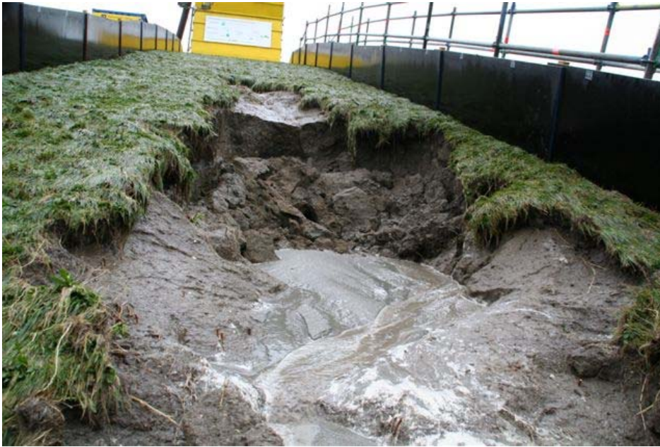
Figuur B12. Eindresultaat Boonweg; sectie 4, na 5 uur en 51 minuten met 75 l/s per m. De zandkern is zeker 1 m diep weggespoeld en aan de rechter zijkant staat de zijwand van de goot op instorten. Eindresultaat na ongeveer 45 minuten na het ontstaan van de eerste "ballon".
