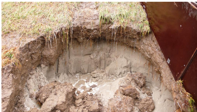
Figuur 7-8 Het ontstane gat tijdens de proef met 50 l/s per m. De overgang tussen de klei- en zandlaag is goed zichtbaar
