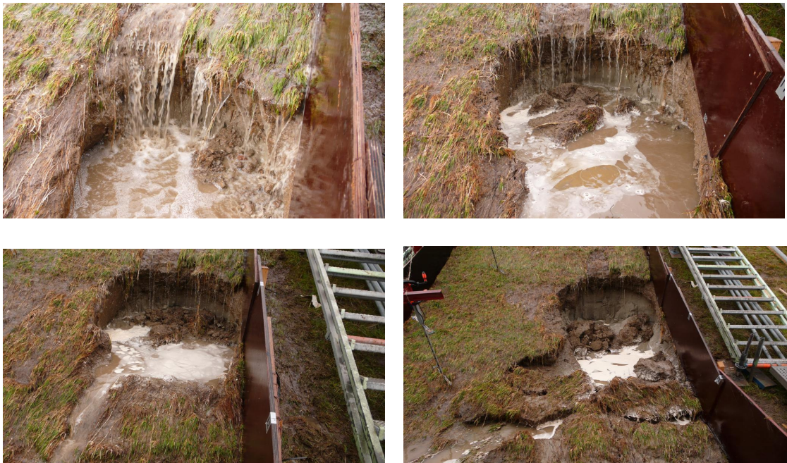
Figuur 7-6 Schadeontwikkeling tijdens de laatste 2 uur van de proef met 50 l/s per m. In de bovenste 6 foto's stroomt het water van rechts naar links. In de andere foto's is dit van boven naar beneden.
