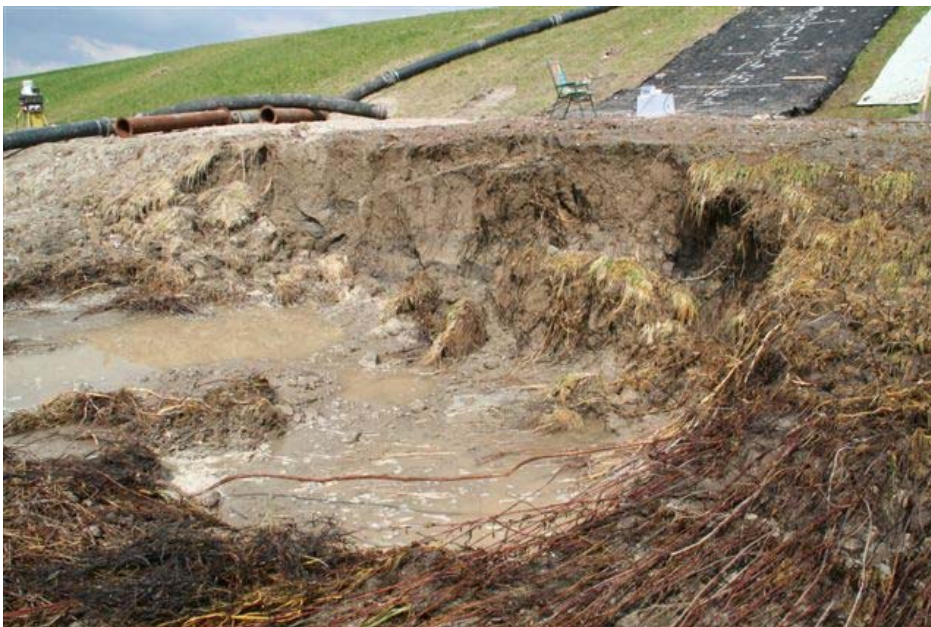
Figuur B31. Eindresultaat Kattendijke; sectie met open asfaltbeton, na 125 l/s per m. Er ontstond een groot erosiegat na de onderhoudsweg van orde 1,5 m diep. De onderhoudsweg zelf was beschermd door platen en kon niet eroderen.
