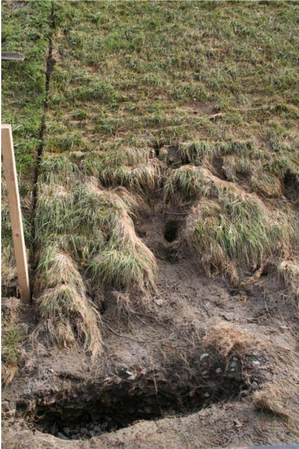
Foto F-18 De in de teen aanwezig grindkoffer is aan het einde van de proef met 50 l/s per m zichtbaar. Een groot gedeelte van de grasbekleding op het horizontale vlak voor de onderhoudsweg was geërodeerd. Het gat links onder aan het talud was echter gedurende de sessie niet groter geworden. Om te voorkomen dat de schade zich bij de proef met 75 l/s per m drastisch zou uitbreiden is besloten de proef te stoppen.
