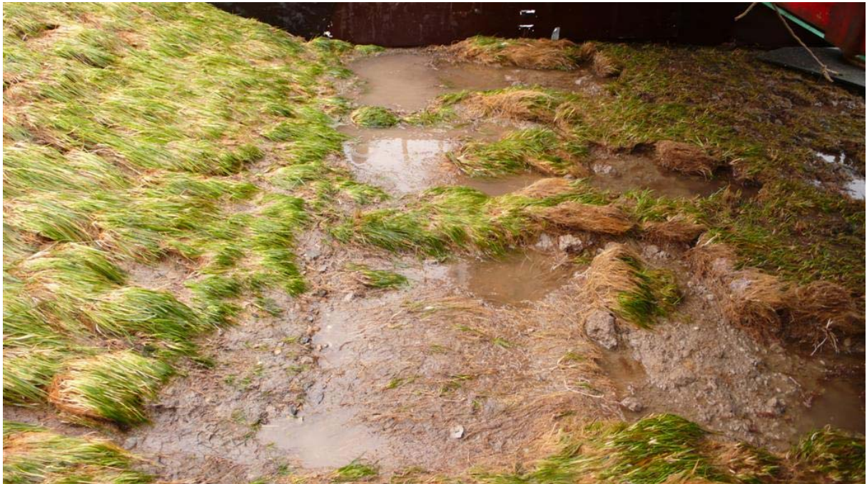
Foto F-9 Aan het eind van de proef met 50 l/s per m was een groot gedeelte van de grasbekleding op het horizontale vlak voor de onderhoudsweg geërodeerd.
