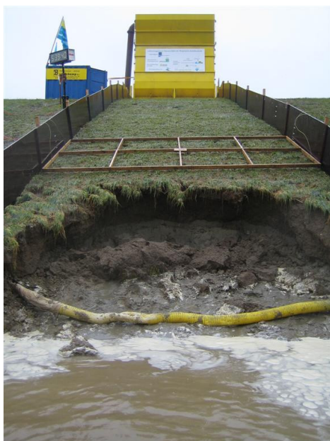
Figuur 8-5 Eindresultaat met blootliggende drainage
