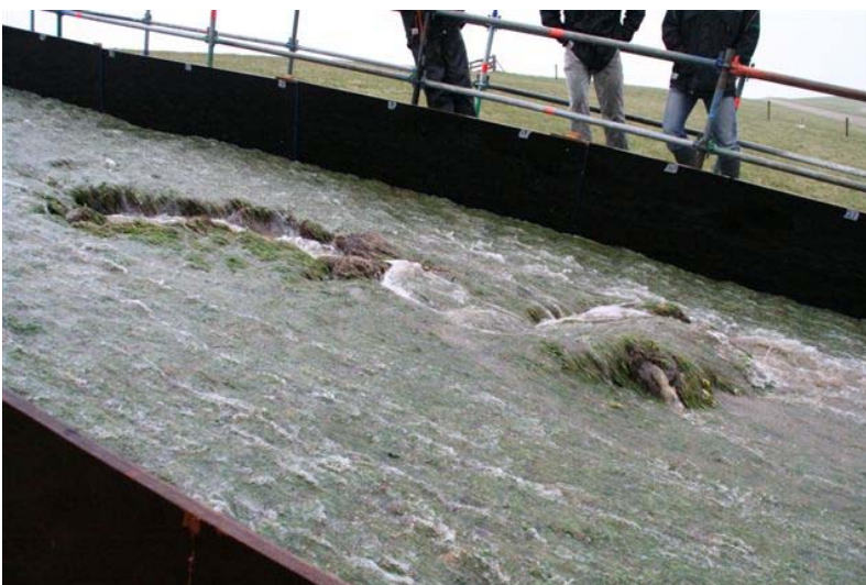
Figuur B9. Boonweg; sectie 4. Na het ontstaan van het gat in figuur 8, de onmiddellijke vorming van een tweede ballon, die aan de onderkant deels "lek" is.
