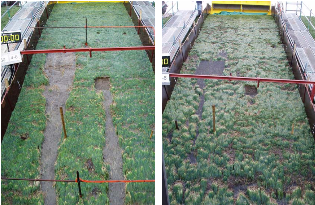
Figuur B1. Eindresultaat Delfzijl. Links de normale dijk na aanbrengen van beschadigingen (1x1x0,05 m; 0,4x0,4x0,15 m; bovenin 2 gaten 0,15x0,15x0,15 m; drie palen in talud) en na 6 uur met 50 l/s per m. Rechts de versterkte SGR-sectie, waarbij geen geulvorming optreedt (op het gewone dijkvak wel).
