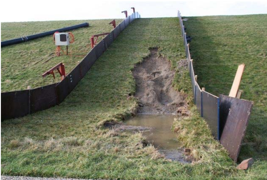
Figuur B6. Eindresultaat Boonweg, sectie 3 (zie ook figuur 5). Het ballonmechanisme ontstond nogmaals in het laatste uur van 75 l/s per m en de twee beschadigingen kwamen uiteindelijk samen. Dit resulteerde in een groot stuk waar de grasmat was weggeslagen, inclusief de teen met klinkerpaadje. Er ontstond echter (nog) geen gat door de kleilaag heen. Resultaat na 75 l/s per m.
