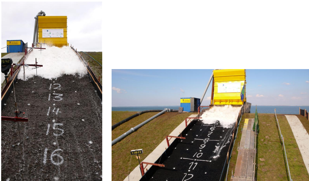
Figuur 10-1 Proeven op Elastocoast® (links) en open steenasfalt (rechts)
