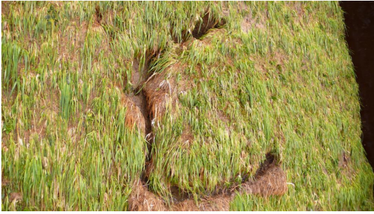
Figuur 9-3 De moot klei met bekleding zakte gedurende de derde sessie weer in
