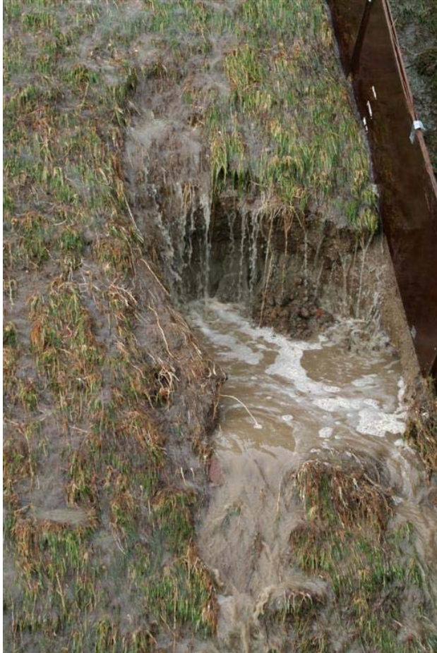
Foto F-5 Het schadebeeld aan de rechterkant van het talud werd langzaam een steeds dieper wordend gat met steile wand aan de bovenstroomse kant (zie ook Figuur 7-6). Hierdoor ontstond langzaam een gat in de kleilaag, waardoor de zandkern bloot kwam te liggen. Toen dit gebeurde versnelde de gatontwikkeling door uitspoelen van zand
