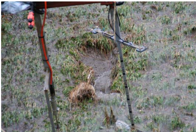
Foto F-3 Het schadebeeld ter plaatse van de meetinstrumenten is tijdens de sessies met 50 l/s per m langzaam langer en breder geworden. De schade is voornamelijk oppervlakkig.
