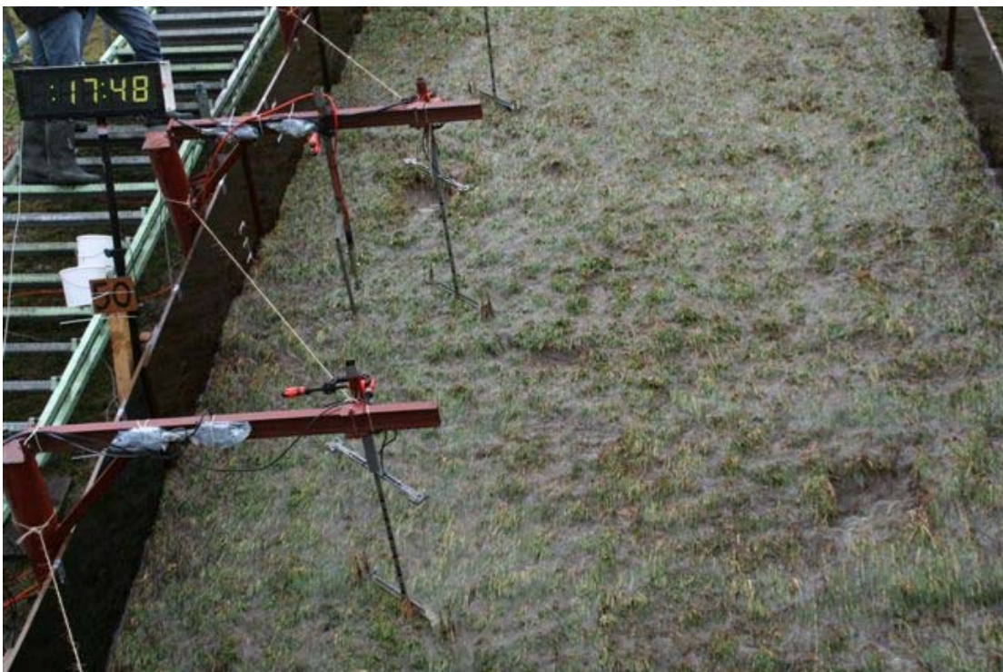
Figuur B13. Initiële schade St Philipsland bij het begin van de 50 l/s per m proef. Een steil binnentalud 1;2,5 en een matige grasbedekking met enkele molshopen. De twee kleine gaten (linksboven tussen de frontnelheidsmeters en rechts beneden) ontstonden tegelijkertijd bij een grote golf aan het begin van de proef. Het gat linksboven heeft zich verder nauwelijks uitgebreid, het gat rechtsonder heeft aan het eind van de proef aanleiding gegeven tot falen.
