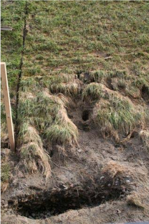
Figuur B28. Eindresultaat Kattendijke; sectie 2, na 50 l/s per m. Schade aan de teen van de dijk (de grindkoffer) begon al bij 30 l/s per m. De verwachting was dat deze schade zich bij 75 l/s per m drastisch zou uitbreiden, gelijk aan sectie 1. Besloten werd deze schade niet opnieuw te laten ontstaan. Verwachting was dat het talud niet verdere schade zou hebben gegeven en belangrijkste doelstelling (effect van gierinjecteur) was bereikt.
