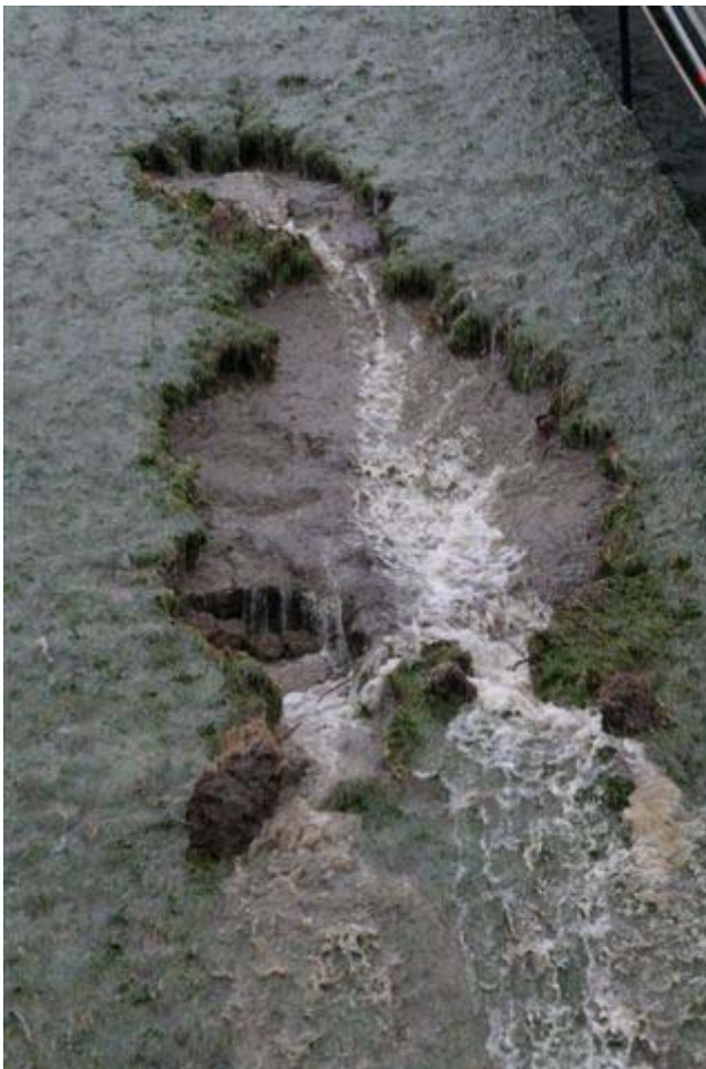
Figuur B11. Boonweg; sectie 4. Ongeveer 5 minuten nadat de tweede ballon is losgeraakt. Links in het midden is een gat in de klei zichtbaar met een verticaal talud. Hier zal het gat zich uitbreiden en de zandkern worden bereikt.
