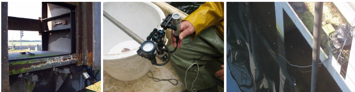
Foto 1, 2 en 3. Links de cameraopstelling linksonder het rinket bij de reservedeur, midden de videocamera met lamp en de sluisdeur met bedrading naar de camera onder water.
