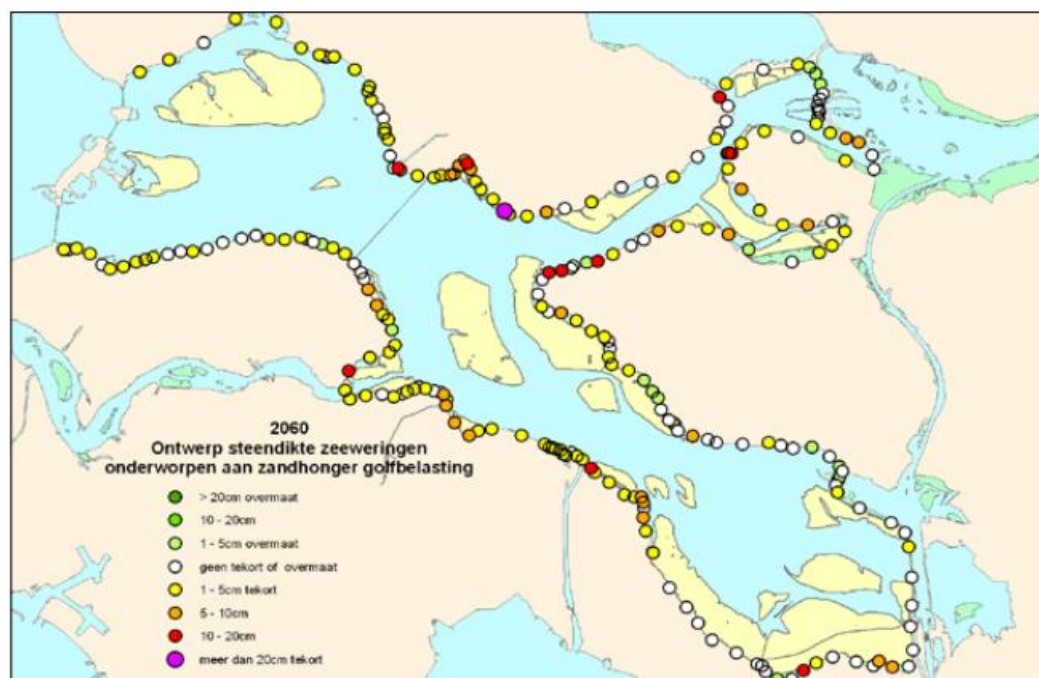
Figuur 4.4: Ontwerp van de steenbekleding in vergelijking met de benodigde dikte van de steenbekleding bij de voorspelde golfbelasting in 2060 (Zanten & Adriaanse, 2008).
