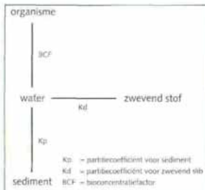
Figuur 7 Schema van de verschillende compartimenten in een aquatisch ecosysteem.
