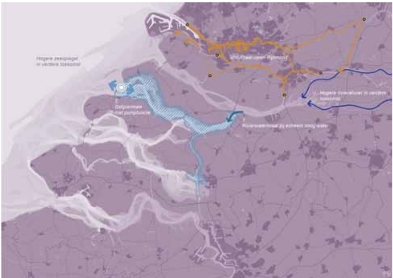
Figuur 4. Combinatie oplossingen waterberging Volkerak-Zoommeer met Grevelingen en 'afsluitbaar-open' Rijnmond (project 4, 5 en 6)
