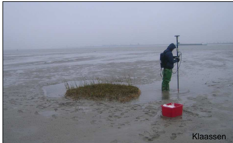
Fig. 6.2 Fieldwork with DGPS Rover at Plaat van Walsoorden
