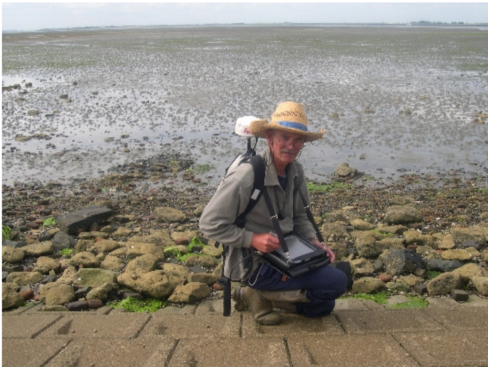
Foto 41: Werkwijze, in het veld werden de gegevens direct in een veldcomputer ingevoerd. De grenzen van de proefvlakken werden met behulp van GPS vastgelegd in de veldcomputer
