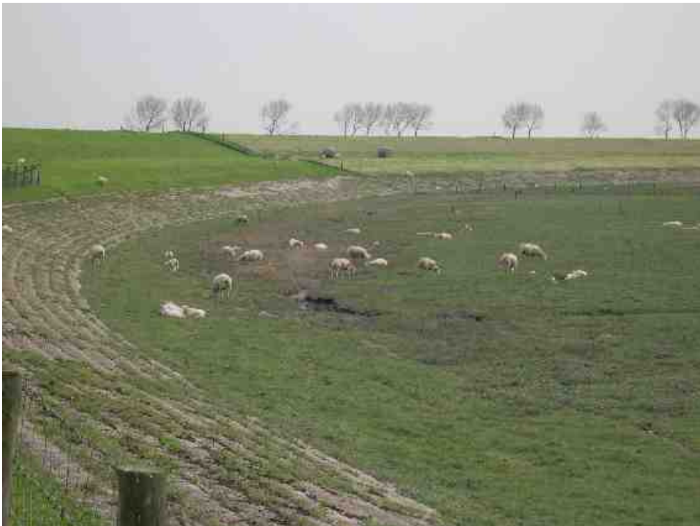
Foto: 12: Proefstrook 8, op de hoger afgewerkte werkstrook ontstaan krimpscheuren door verdroging
