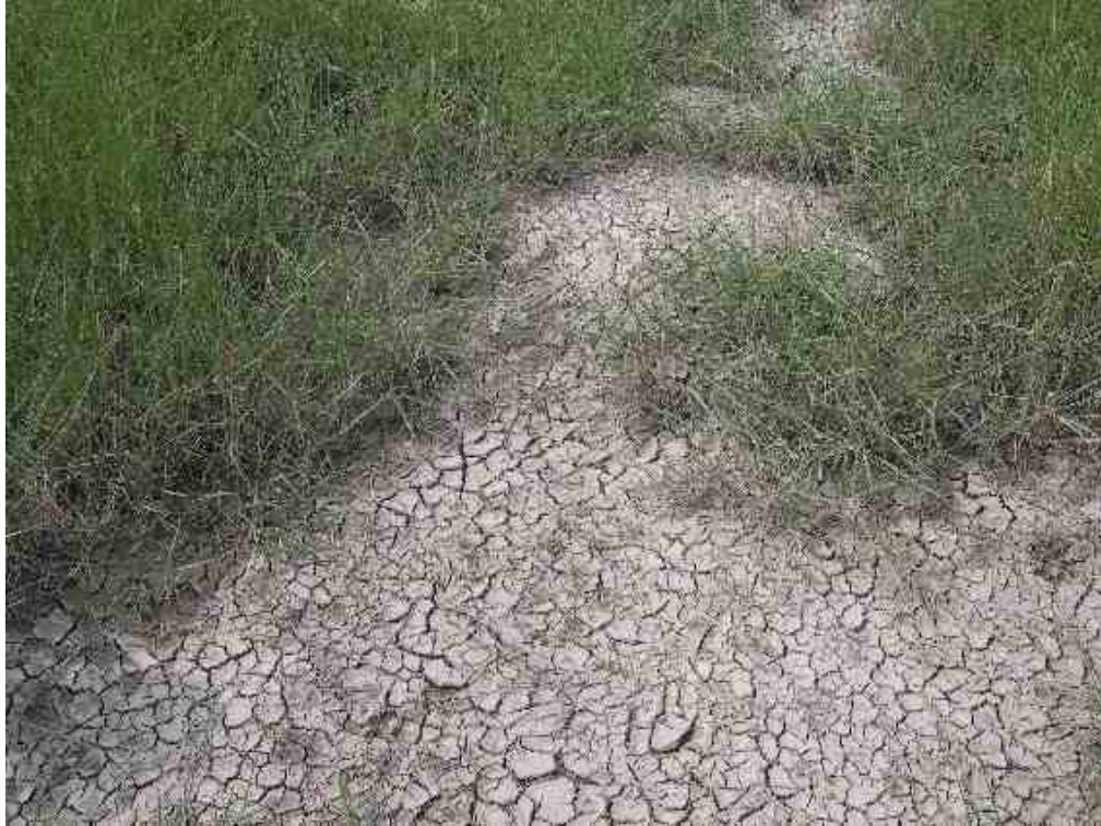
Foto: 12: Proefstrook 8, op de hoger afgewerkte werkstrook ontstaan krimpscheuren door verdroging
