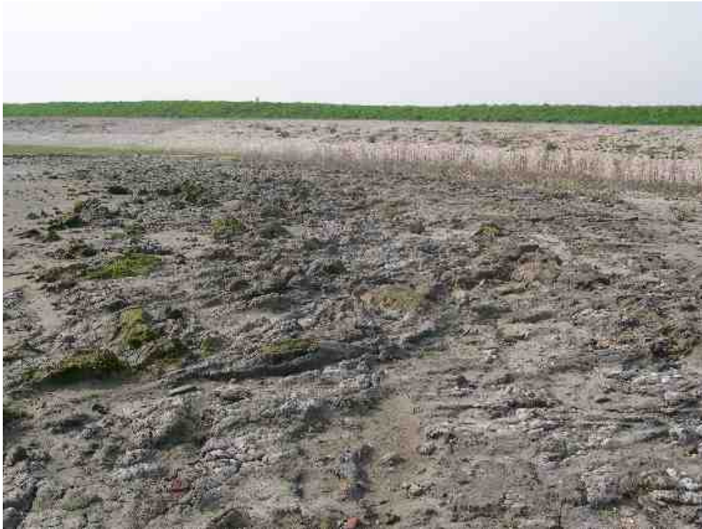
Foto 16: Proefstrook 13, vergraven schor is gevoeliger voor erosie. Door het vergraven is het verband weg en spoelen zandige delen makkelijker weg en blijven er hompen klei, afgerond door erosie, over.
