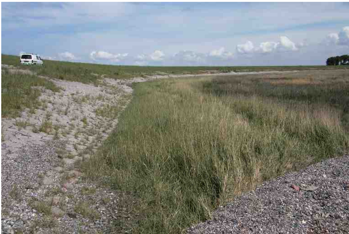
Foto 27: Proefstrook 24, duidelijk band van afwijkende vegetatie langs de dijk, dit is een gevolg van het hoger afwerken van de werkstrook deze ligt zeker meer dan 15 cm hoger dan het originele schor
