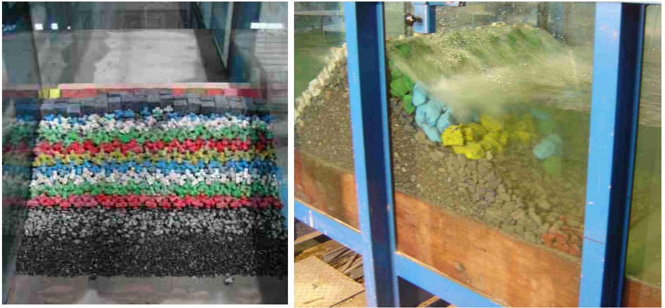
afbeelding 3.13. Schaalmodelonderzoek: betonnen elementen (links) en breuksteen (rechts)
