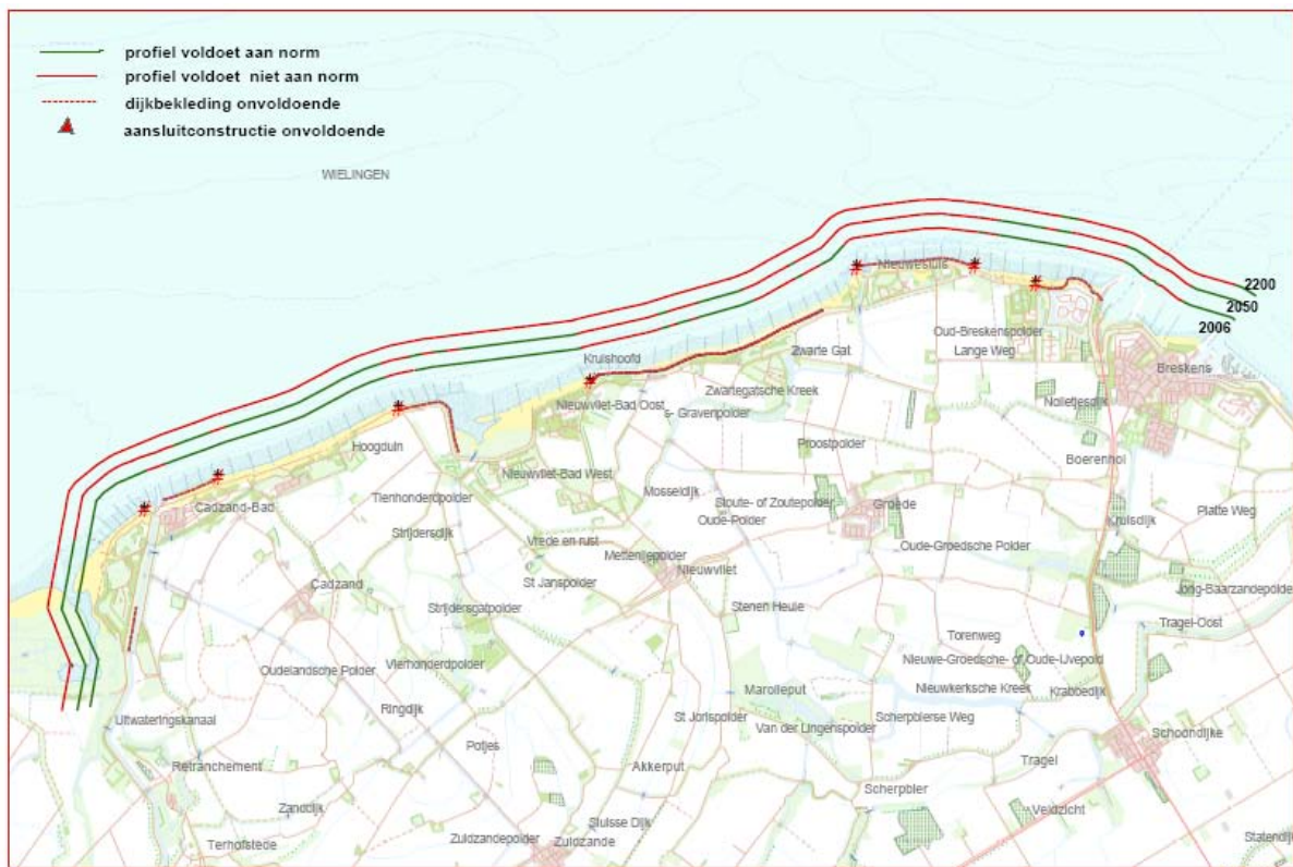
Figuur 2-3: kustveiligheid onder invloed van zeespiegelstijging in West Zeeuwsch-Vlaanderen tot het jaar 2200
