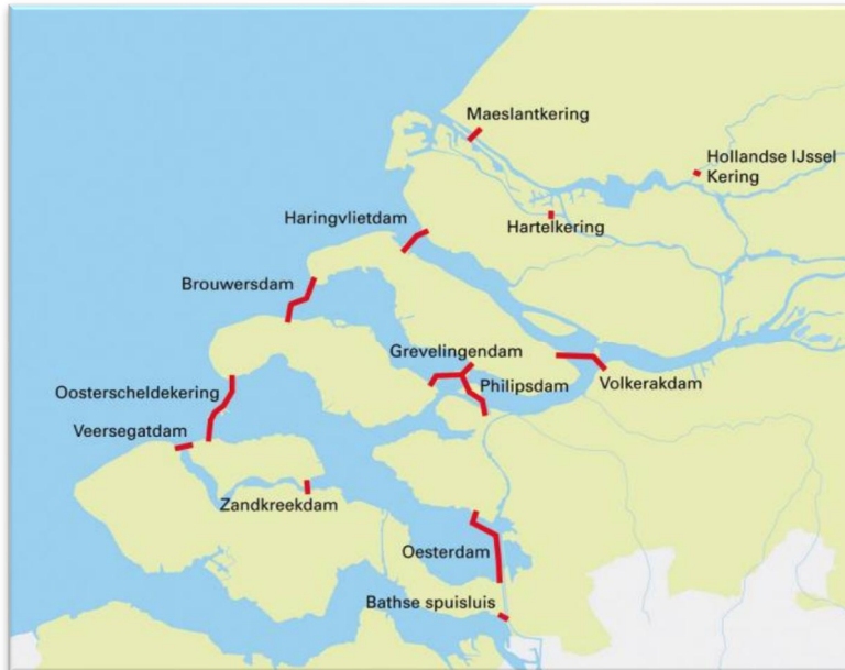
Figuur 5.2 Overzicht van de dammen en stormvloedkeringen in de Rijn-Maasmond en Zuidwestelijke Delta
