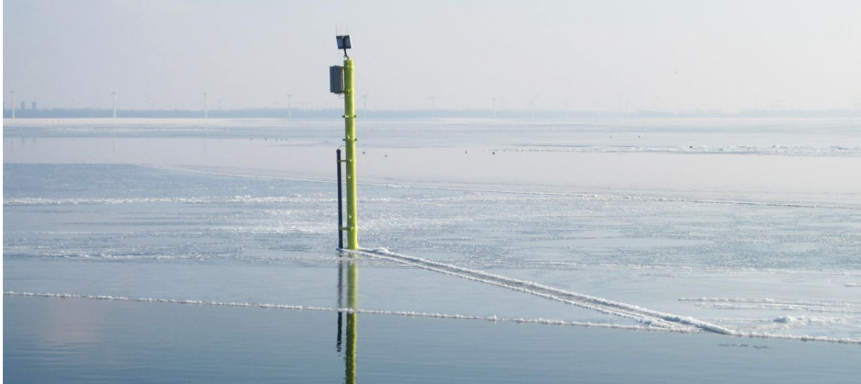
Figuur 5: Zwevend stof meetpaal en ijsgang op de Oosterschelde feb. 2012
