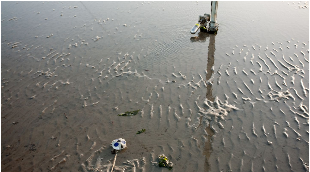
Figuur 8: foto met Drukdoos en Aquadopp in beeld.
