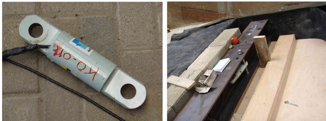
a) Links: krachtopnemer (15 ton bereik), rechts: inbouw van krachtopnemer
