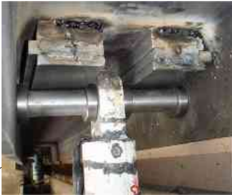
ondersteuning van staaf door krachtopnemer
