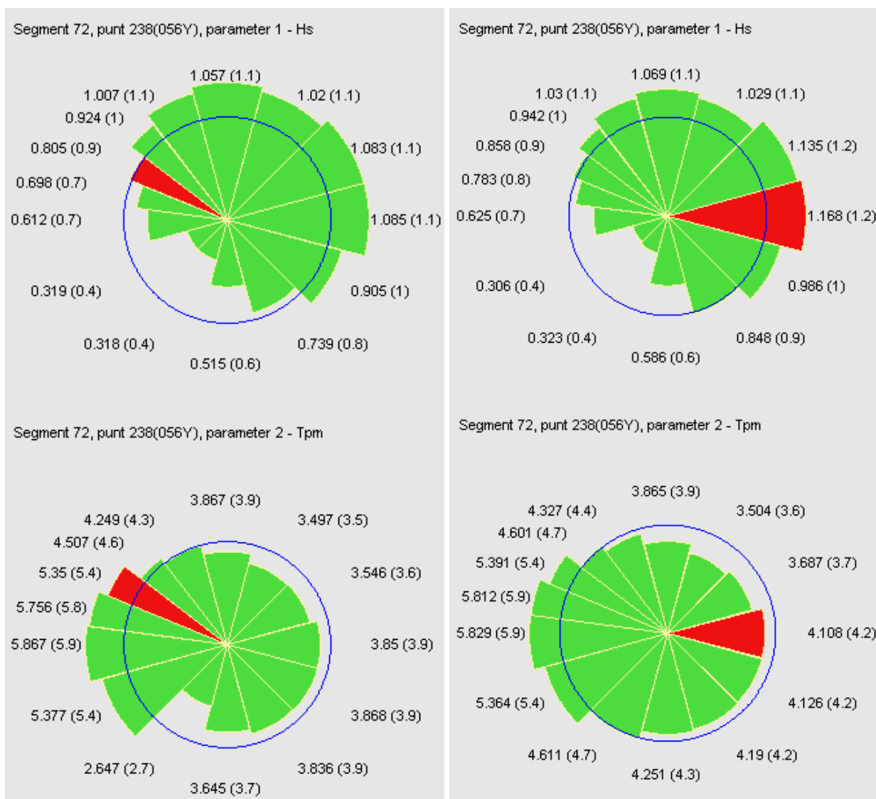
Figuur 7.13: Gecorrigeerde golfcondities o.b.v ontwerp bodem en prognose bodem voor alle beschouwde windrichtingen bij waterstand NAP +2m (rood is maatgevende windrichting)
