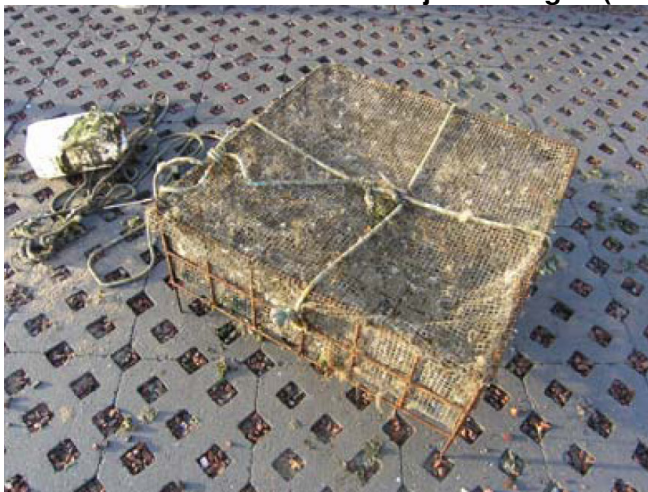
afbeelding 7.2. Bovenaanzicht van een mand waarin mosselen zijn geplaatst voor het uitvoeren van onafhankelijke metingen (uit [ref. 7.]).
