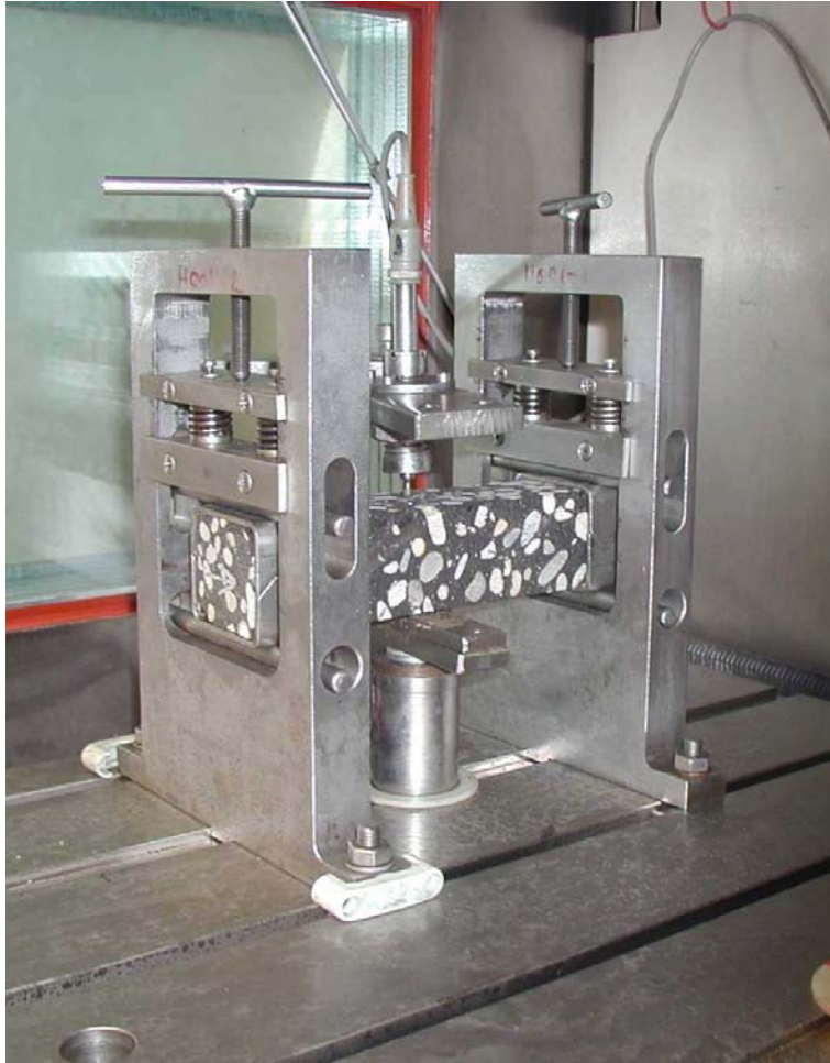
Figuur 4.2: Opstelling driepuntsbuigproef met 4-puntsbuigportalen
