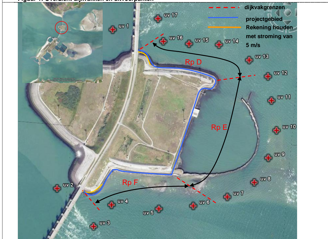
Figuur 1: Overzicht dijkvakken en uitvoerpunten
