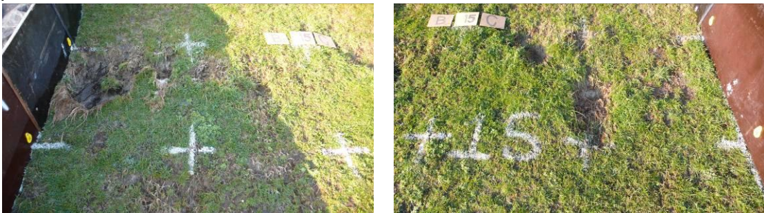
Foto 3.34 Erosiegaten direct na de teen
