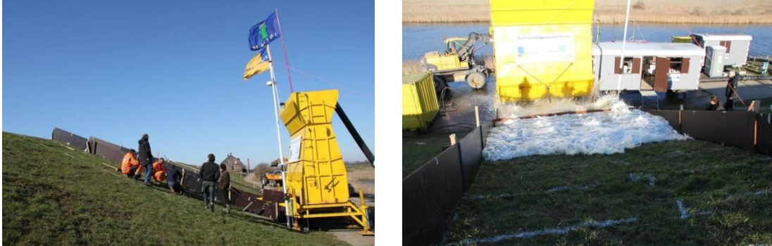
Foto 2.6 Opstelling en uitvoering van de kalibratie op het binnentalud
