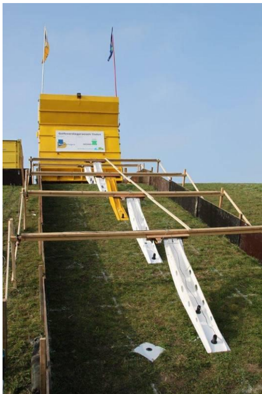
Foto B4.2 Opzet hydraulische metingen binnentalud Tholen met 5 surfplanken 7 paddle wheels
