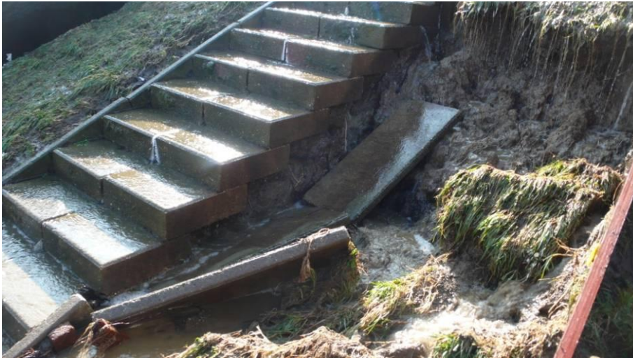
Foto 3.10 De eerste opsluitbanden slaan eruit bij golf 236.
