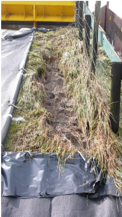
Foto 3.28 Erosie grasbekleding in vak 5C, 6C, 7C
