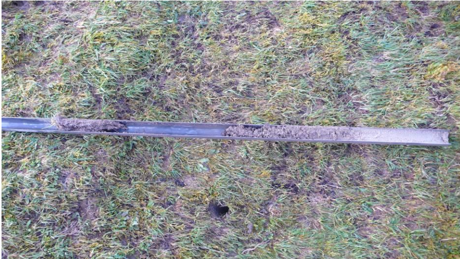
Foto 3.47 Resultaat gutsboring: graszode, lucht, klei en zand
