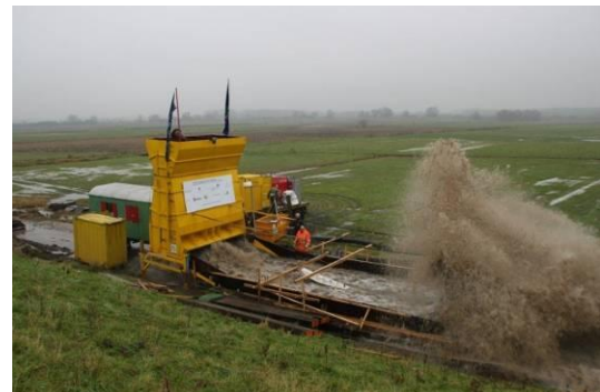
Foto B4.1 Proeven in België, 2010, waarbij krachten op verticale platen werden gemeten. De surfplank heeft laagdikte en snelheid gemeten.
