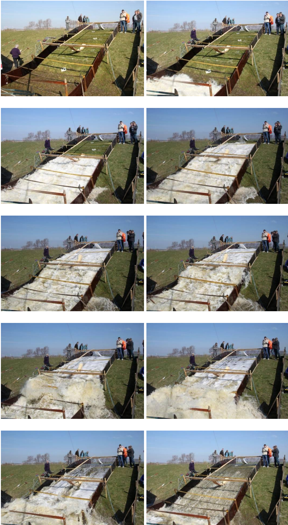
Foto B4.5 Gesimuleerde golfploop en -neerloop. Volume 5500 l/m.
