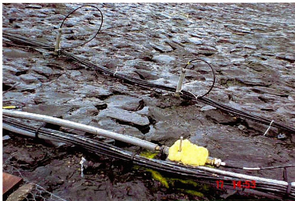
Detail meetraai, op de voorgrond de drukopnemers voor de verplaatsingsmeting, op de achtergrond de drukopnemers voor het meten van de druk onder de bekleding
