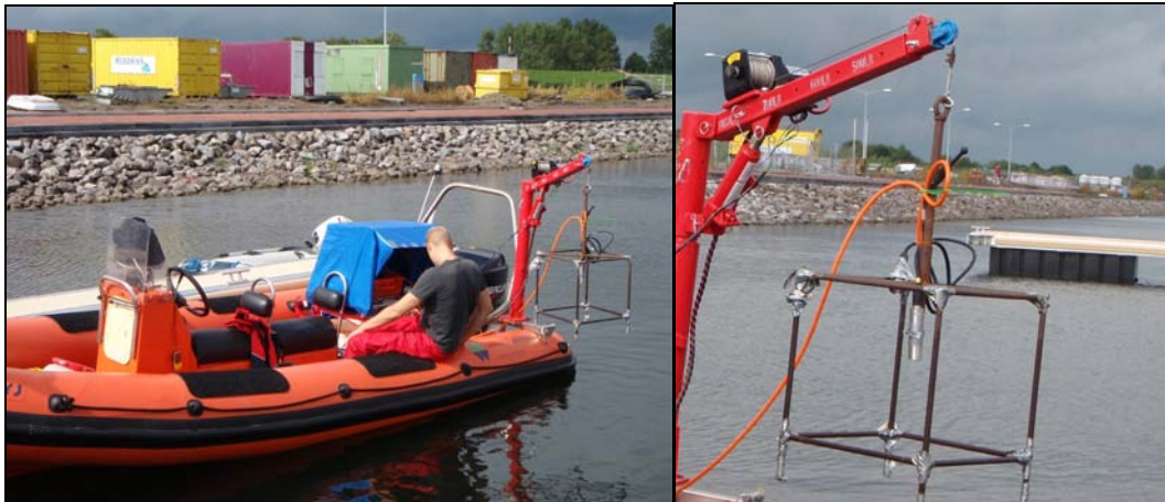
Figuur 2.2. Links: Het vaartuig met kraan en videosysteem. Rechts: Het statief met camera en verlichting aan de kraan.
