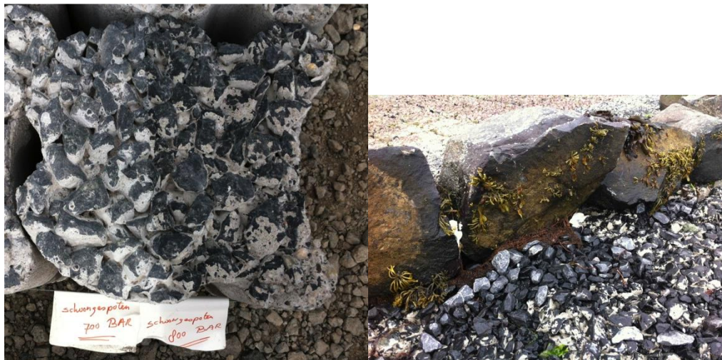
Afbeelding 6. Links: Diverse behandelingen met de hoge drukreiniger, gebruikt om de betonsluier te verwijderen. Rechts: Overmaat aan steenslag hoopt zich op bij groefwier begroeiing.
