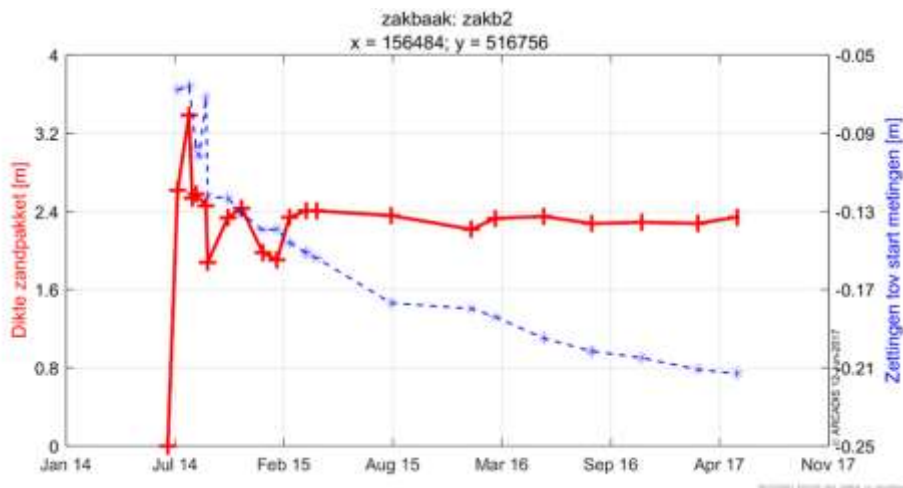
Figuur 6-44 Opgetreden zettingen in relatie met de dikte van het zandpakket in zakb2.
