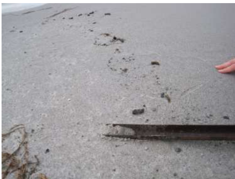
Figuur 7-2 Horizontale monsternamen met grondboor zodat alleen de bovenste 0,5 cm wordt bemonsterd.
