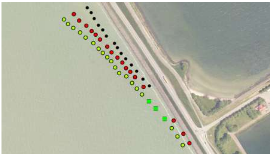
Figuur 7-1 Ligging monsterpunten grid. Raai 1 = groen, raai 2 = rood, raai 3 = zwart. Raai 1 is genummerd van NW-ZO 1 t/m 22 (rijsmat is nummers 17, 18 en 19, groene diamanten), raai 2 is genummerd van ZO-NW 23 t/m 39, raai 3 is genummerd van NW-ZO 40 t/m 53
