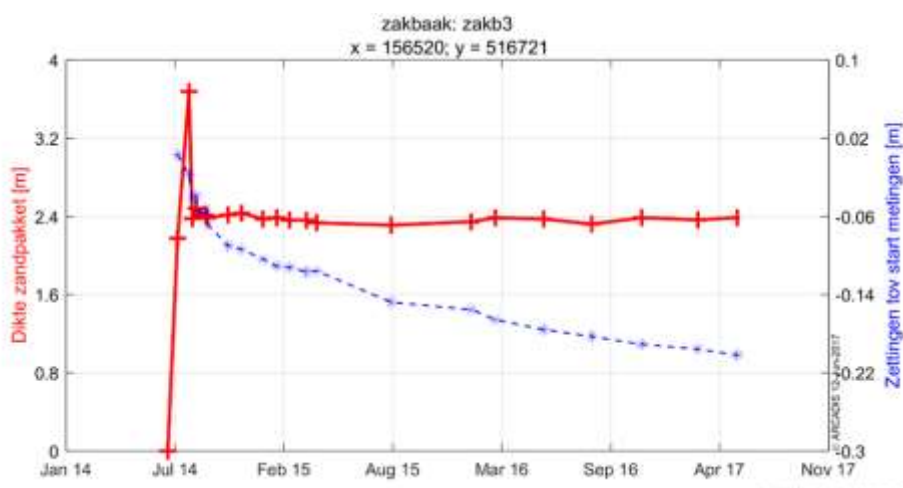
Figuur 6-45 Opgetreden zettingen in relatie met de dikte van het zandpakket in zakb3.
