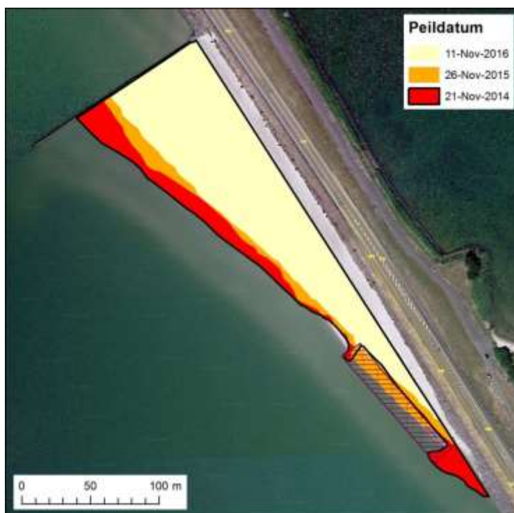
Figuur 7.3 De zandafslag en toename van de zandige vooroever aan de houtribdijk in de november maand van 2014, 2015 en 2016. De zwarte polygoon geeft de oorspronkelijke vorm weer van de vooroever, zoals aanwezig op 21 november 2014. De gevlochten wilgenmatten zijn hierin gearceerd weergegeven.
