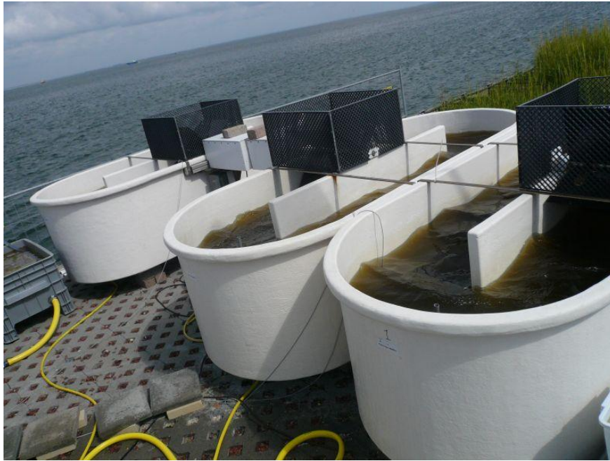
Fig. 11. Raceway 1 tot en met 3 op 26 juli met Chaetoceros muelleri in batch fase.
