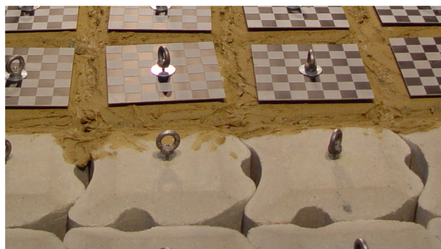
Figuur 3-9: Foto links: ingewassen toplaag, foto rechts: inzanding met klei-zand mengsel
