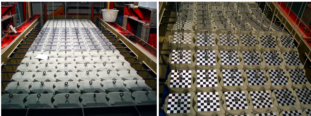
Figuur 5-2: Proefstuk van Hydroblocks onbelast en belast
