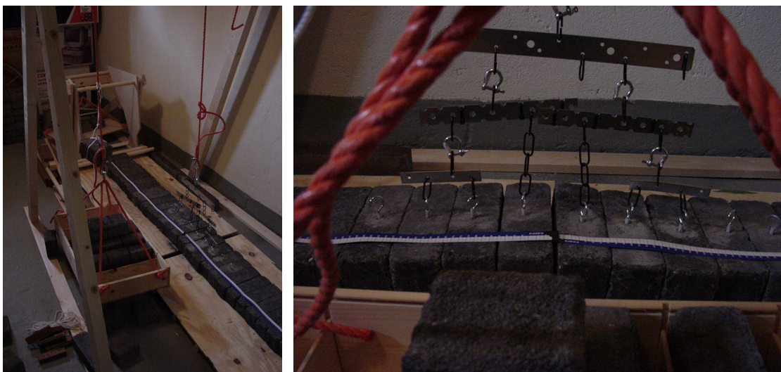
Figuur 3-5: Links: Testopstelling voor proevenserie 2 met rij waalformaat straatstenen Rechts: Belasting proefstuk met krachten op 6 elementen in onderlinge verhouding van 0.4 : 0.6 : 1.0 : 1.0 : 0.6 : 0.4
