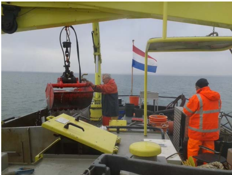
Figuur 2: Monsternamen in de Oosterschelde met de hydraulische happer aan boord van MS Regulus. (Sampling oysters in the Eastern Scheldt, using the hydraulic grab on board of Mv Regulus).
