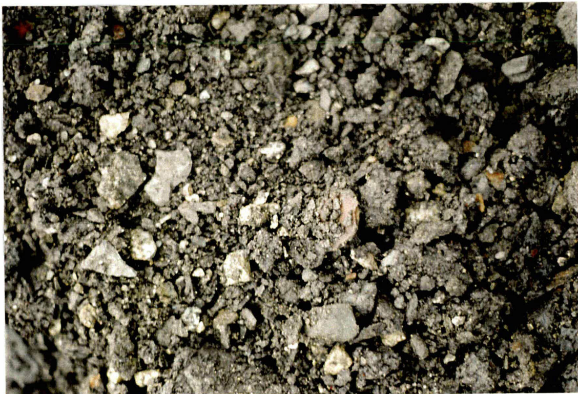
Foto 4 Filter van fosforslakken (dp 69)
